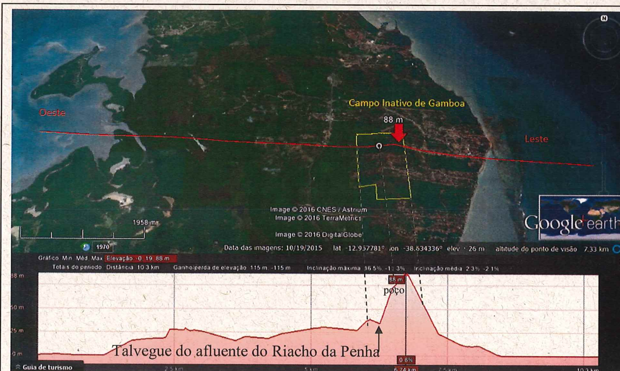
Figura 5.3.1.2-3: Perfil do relevo Oeste–Leste indicado na imagem, com delineação da poligonal do Campo Inativo de Gamboa.
