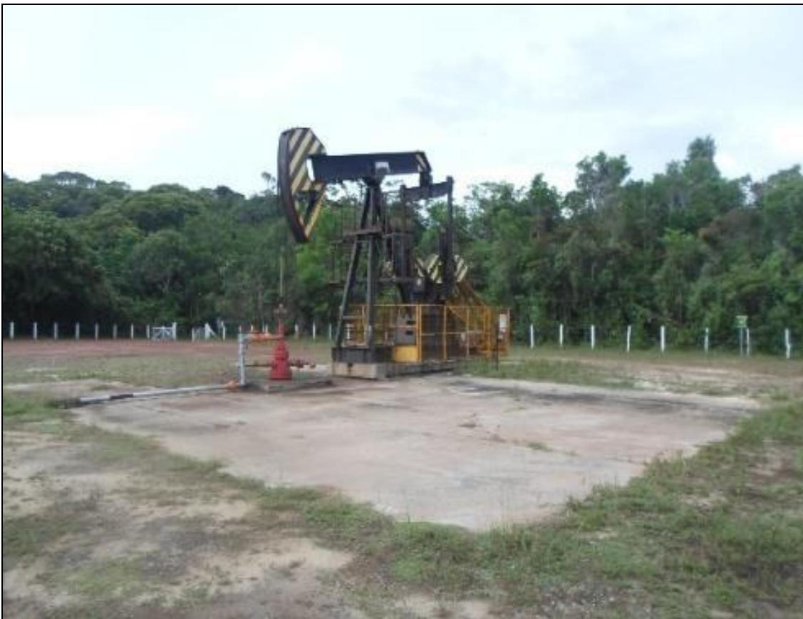
O poço está equipado com uma unidade de Bombeio Mecânico e a sua locação contempla uma linha de coleta, um tanque de armazenamento, bases de concreto e instalações elétricas.
