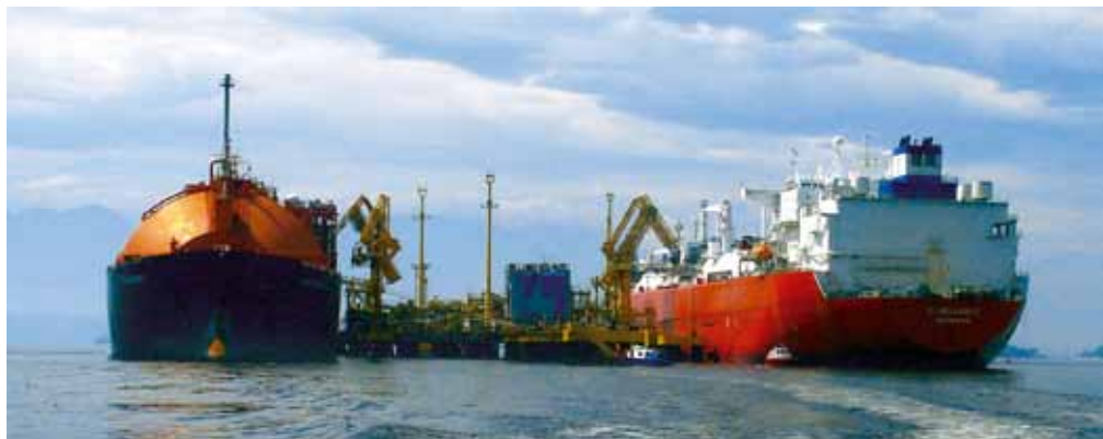
Figura VIII.1 - Visão panorâmica do Projeto GNL da Baía de Guanabara, mostrando o navio regaseificador Golar Spirit à esquerda e o navio supridor Excellence à direita.
