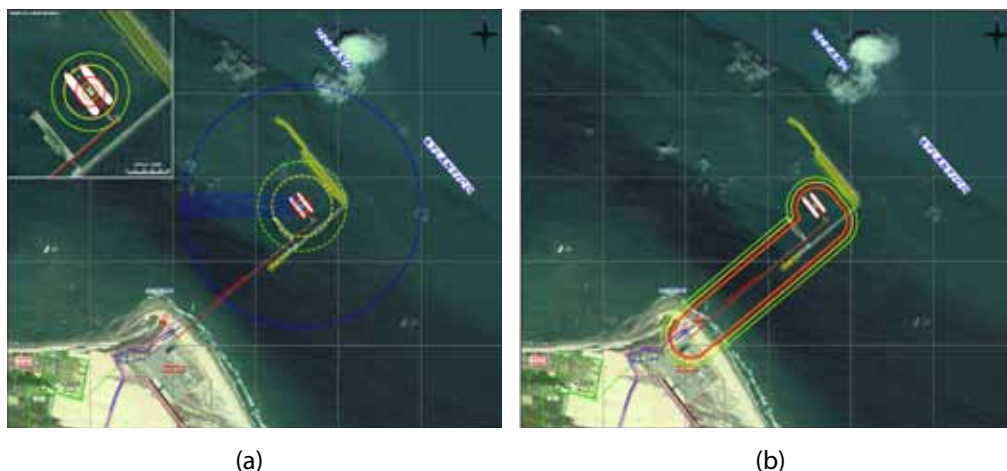
Figura VIII.8 - Resultados dos modelos de vazamento para os piores casos identificados no Projeto GNL de Pecém: (a) Pier e (b) Gasoduto.
