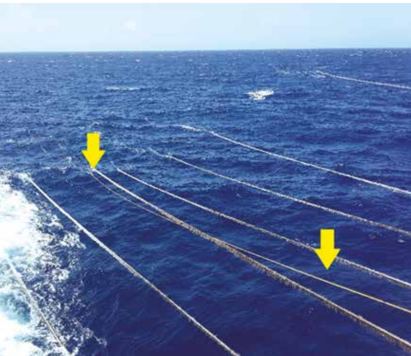
Figura 4 – Cabo MAP utilizado para o monitoramento
