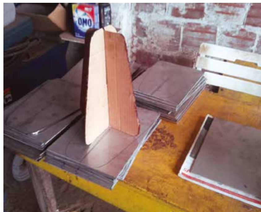
Figura 4 – Detalhe do protótipo de papelão do defletor de radar sobre chapas de aço inox já riscadas para corte
