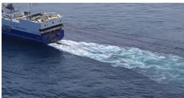
Navio de aquisição sísmica em operação.
