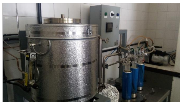
Planta para pirólise – geração de hidrocarbonetos.
