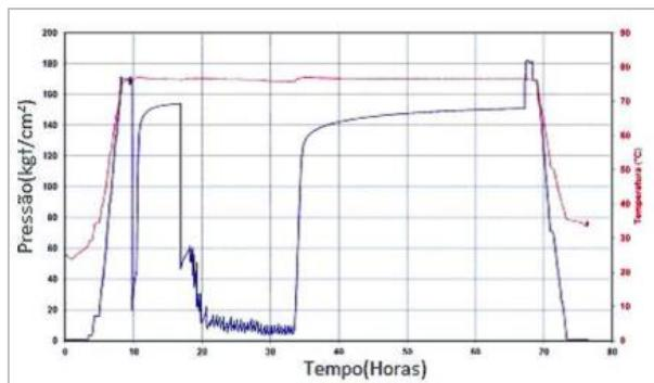
**Testes de Formação (TFR) e Testes de Longa Duração (TLD)** são registros gerados quando um poço é submetido a testes para verificar se uma determinada formação (camada de rocha) pode produzir petróleo ou gás em quantidade e pressão comercial. Validam o potencial produtivo da rocha. Os dados incluem pressão, volume de fluidos, tempo de fluxo, curva de resposta da formação, além de relatórios e gráficos de interpretação.
