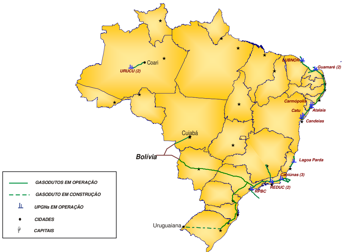
Cartograma 2.2 – Infra-estrutura para a movimentação de gás natural – 2000
