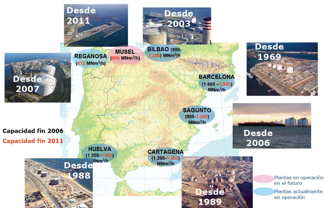
Figura VI.7. Instalações de Regaseificação de GNL Espanha (ANP, 2008b).
