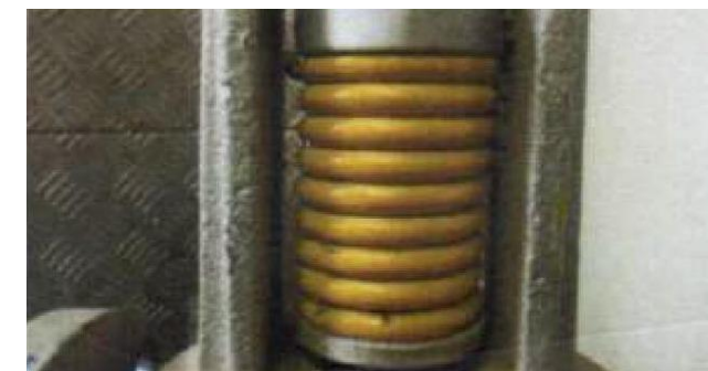
Mola da PSV totalmente comprimida, Norbe VIII. Foto: ANP, relatório de investigação
