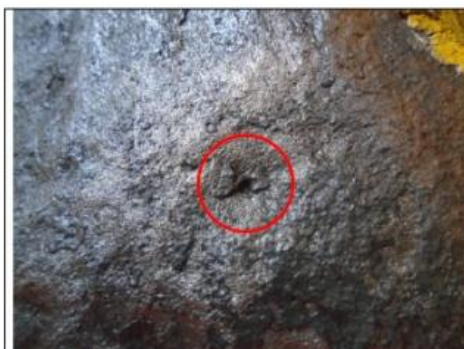
Foto 19: Corrosão de média intensidade com pit's
