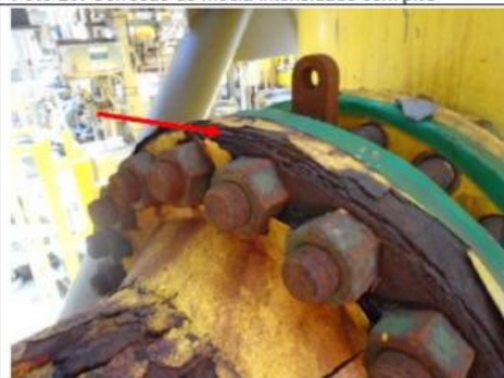
Foto 22: Corrosão de média intensidade
