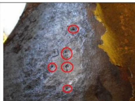
Foto 20: Corrosão de média intensidade com pit's
