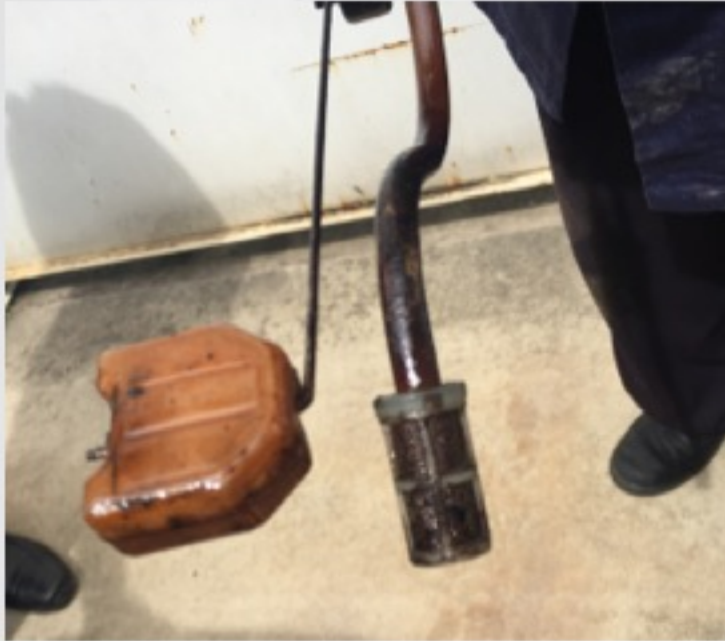
Alta contaminação por diesel degradado
