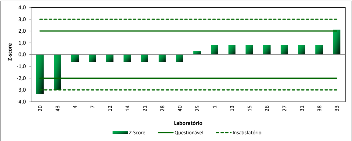
Figura 9. Representação das médias dos resultados obtidos para Ponto de Fluidez.
