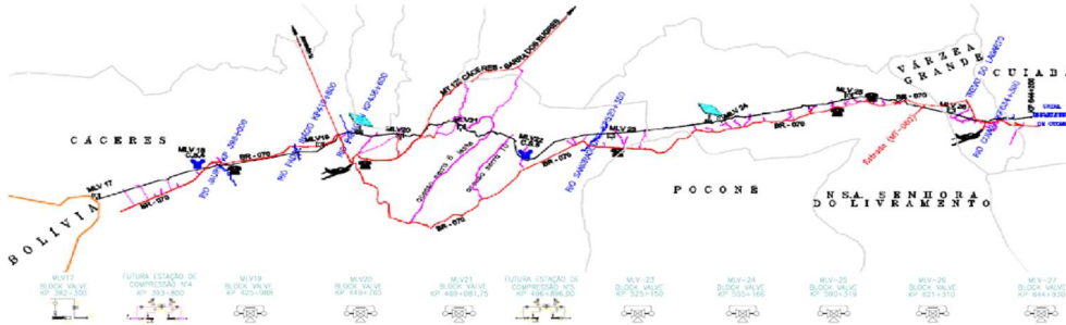
Figura 2 - Distribuição das válvulas principais de linha no gasoduto.
