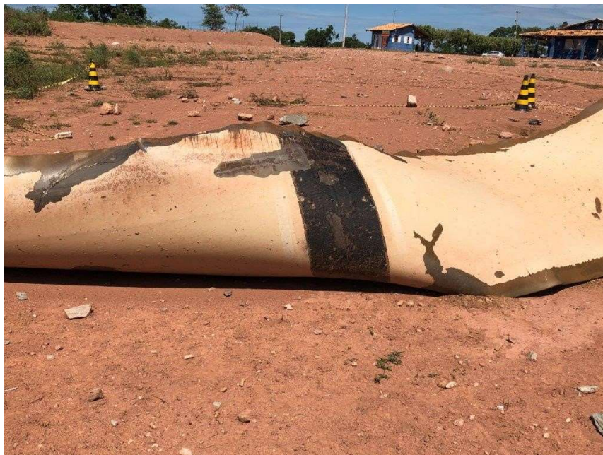
Figura 11 – Vista das ranhuras superficiais localizados próximos a junta circunferencial
