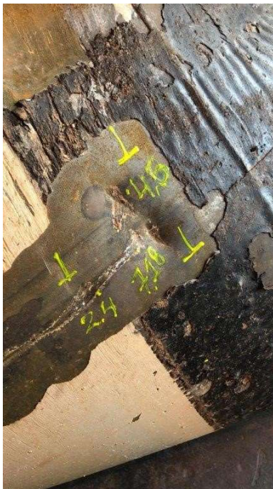
Figura 13 - Danos mecânicos (mossas) produzidos por ação de terceiros e detalhe da deformação plástica
