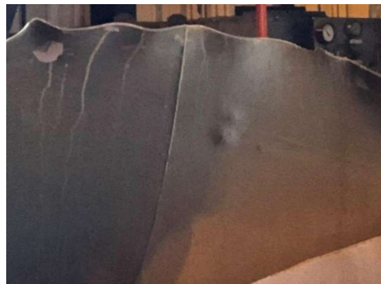
Figura 13 - Danos mecânicos (mossas) produzidos por ação de terceiros e detalhe da deformação plástica
