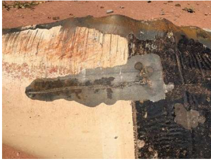
Figura 12 - Mossas e danos mecânicos devido a ação externa
