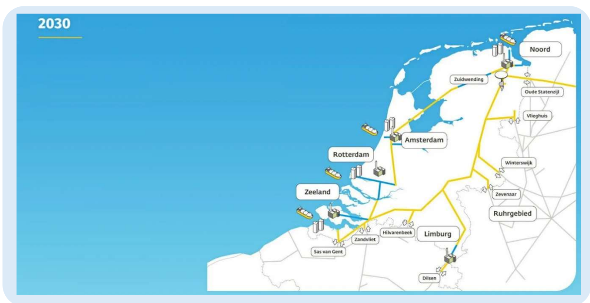
Figura 4 – Rede holandesa planejada de H 2 para 2030, conectando hubs industriais de Roterdã, Amsterdã, Zeeland e Limburg (Fonte: Hynetwork/Gasunie). [40]
