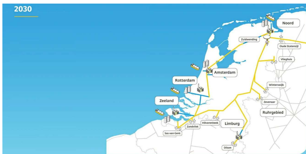
Figura 5 – Rede de dutos de hidrogênio prevista para 2030 nos Países Baixos. As linhas amarelas indicam gasodutos de gás natural reaproveitados; as linhas azuis, novos dutos. Fonte: MFAT (2022).
