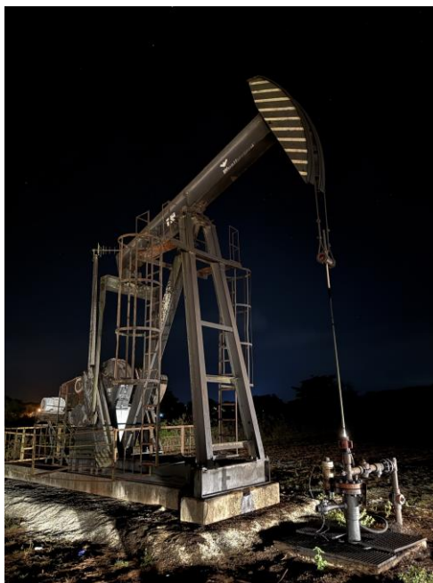
Figura 3 – Unidade de Bombeio Mecânico do poço 7-RO-0489D-SE.
