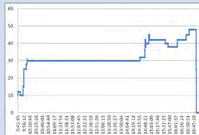
Figura 116 – Gráficos de vazão de vapor para a bomba de stripping
