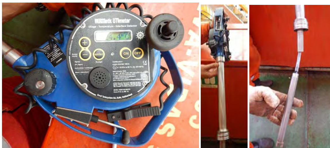
Figura 67 – Fotografias frontal e lateral do medidor UTI
