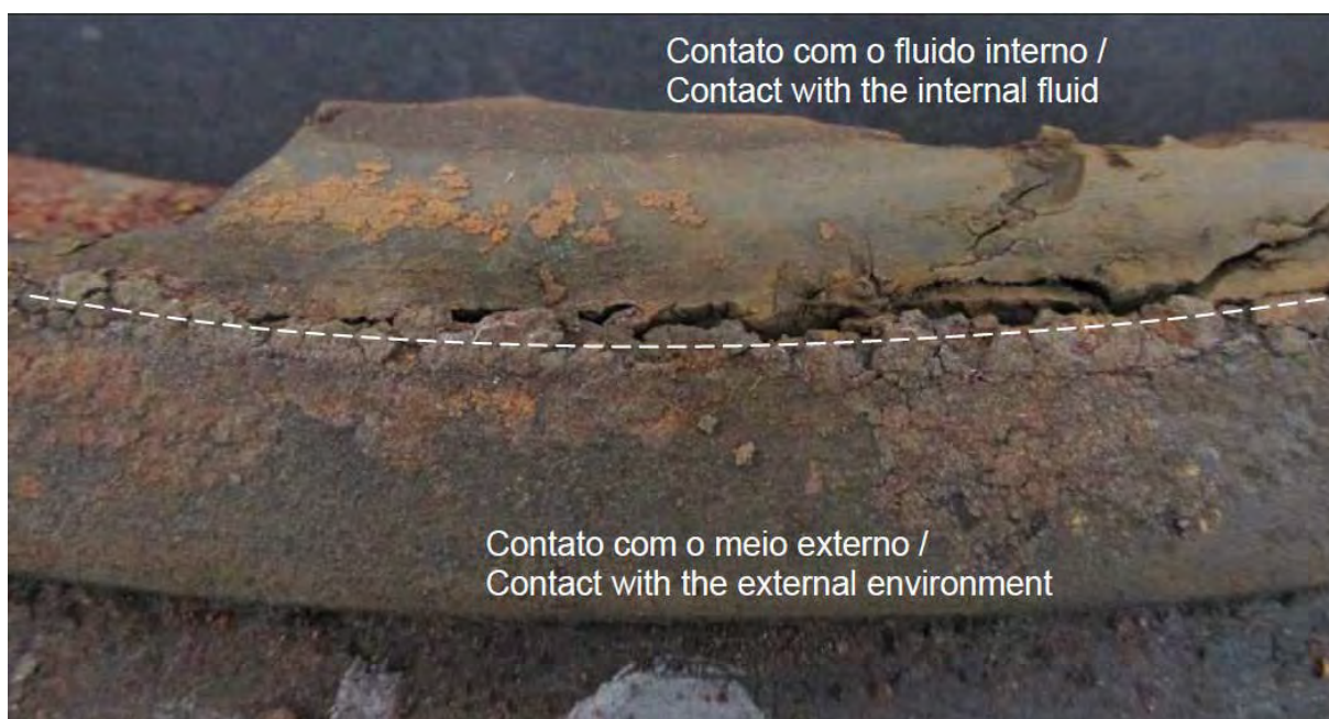
Figura 73 – Aspecto macroscópico do selo de vedação falhado, apresentando trincas no sentido longitudinal e transversal e fratura próxima à região de transição de contato com o fluido e com o meio externo
