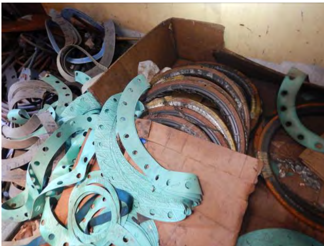
Figura 82 – Alguns dos selos de vedação ( seat rings ) substituídos com o objetivo de corrigir os problemas das válvulas do sistema de carga.
