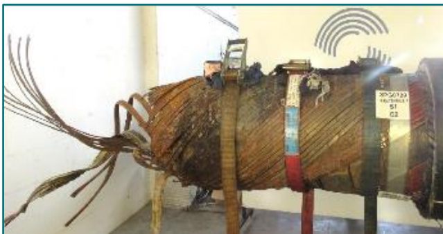
Figura 4 – Corrosão severa da armadura de tração na extremidade da seção rompida do riser
