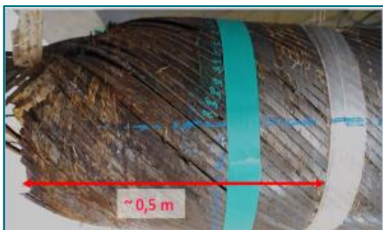
Figura 5 – Corrosão severa da armadura de tração na extremidade da seção rompida do riser (~0,5m)
