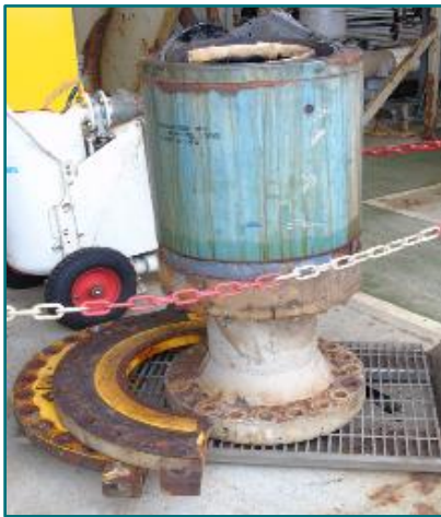
Figura 2 – Terminação ( end fitting ) do riser
