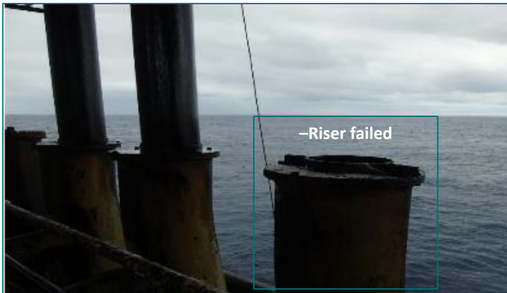
Figura 1 – Localização do I-tube do riser rompido ( spider deck )
