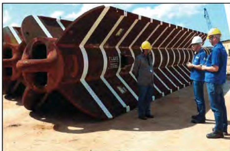
Figura 3: Foto ilustrativa das estacas torpedo utilizadas no sistema de ancoragem do FPSO Piranema (massa de cada um dos torpedos: 98 toneladas).
