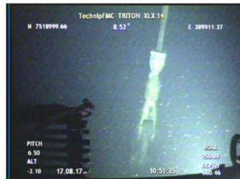
Foto 18 – Conexão entre fim da amarra de fundo e início do cabo do sistema #8 de ancoragem da P-35
