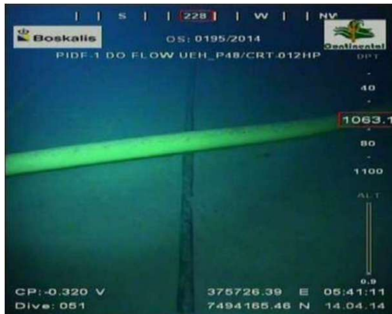
Figura 5.3.2-VI - Exemplo de cruzamento de um duto flexível de escoamento de óleo sobre um umbilical.
