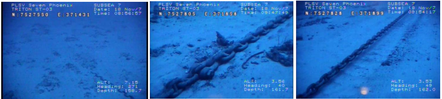
Figura 6.2.3-V: Fotos tiradas durante inspeção da linha de ancoragem #4, em 2017, mostrando (da esquerda para a direita): posição da âncora, amarra apoiada no leito marinho e região do TDP.
