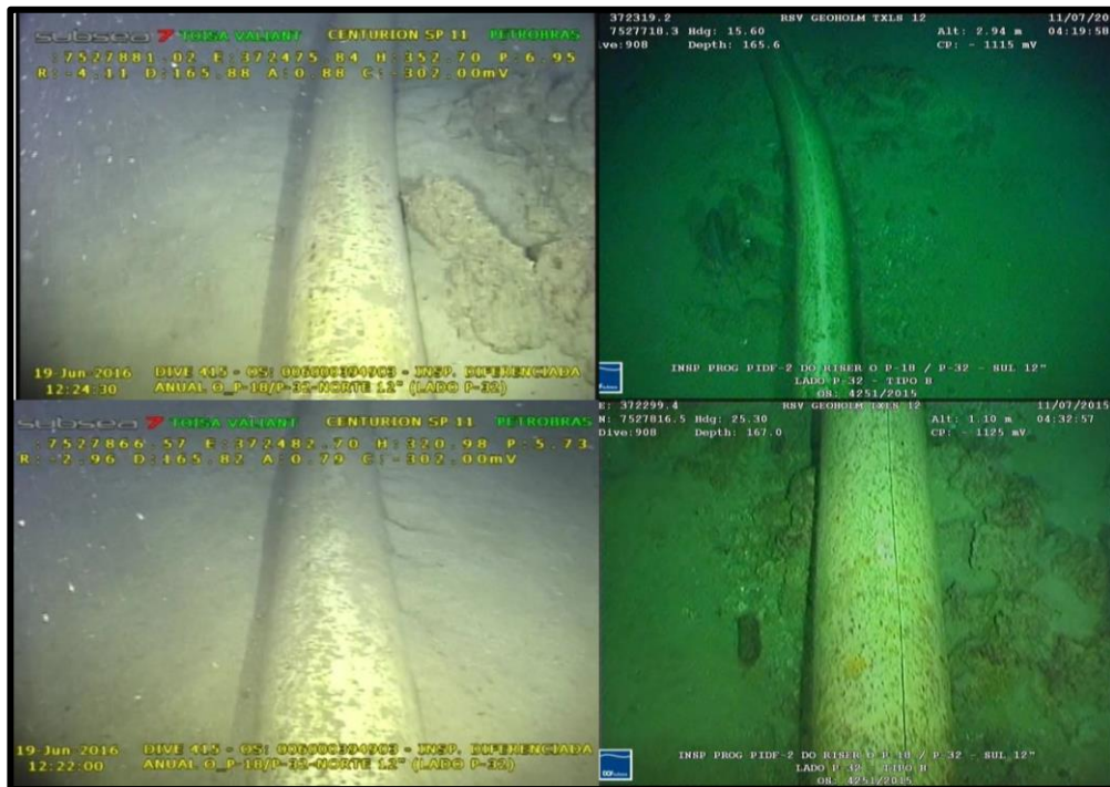
Figura 7.1-II: Exemplos dos tipos de fundo encontrados sob os risers da P-32. Esquerda: Oleoduto P-18/P-32 Norte; direita: Oleoduto P-18/P-32 Sul. O predomínio é de sedimento com algumas feições abrasivas, sem presença de algas calcárias.
