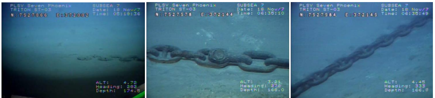
Figura 6.2.3-VI: Fotos tiradas durante inspeção da linha de ancoragem #5, em 2017, mostrando (da esquerda para a direita): posição da âncora, amarra apoiada no leito marinho e região do TDP.
