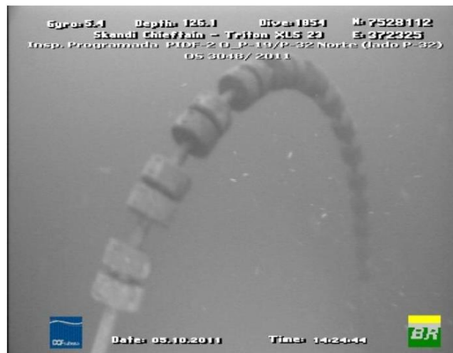
Figura 5.XI: Corcova com flutuadores da configuração pliant wave do riser do Oleoduto P-19/P-32 Norte. Foto tirada durante inspeção realizada em 2011.
