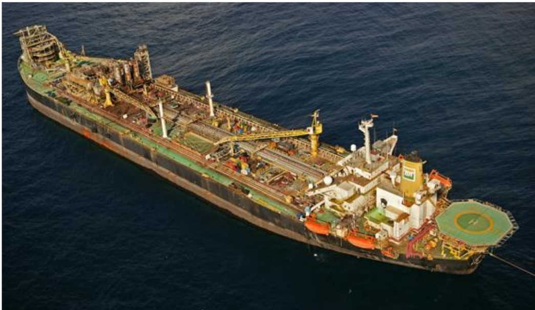
Figura 6.2-I: Foto da P-32 em sua locação (Campo de Viola), mostrando o turrel localizado na proa da plataforma, a planta de processo em sua parte central e o heliponto na popa.
