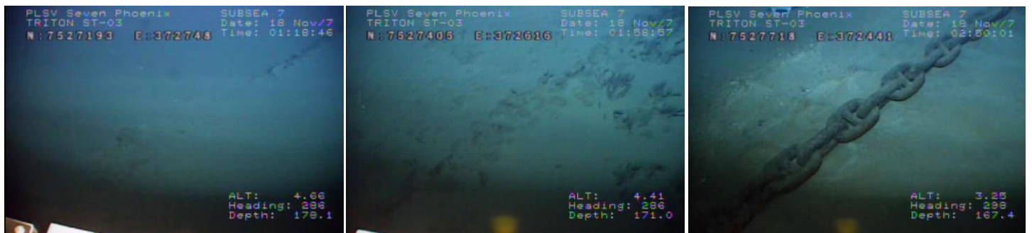
Figura 6.2.3-VII: Fotos tiradas durante inspeção da linha de ancoragem #6, em 2017, mostrando (da esquerda para a direita): posição da âncora, amarra soterrada no leito marinho e região do TDP.
