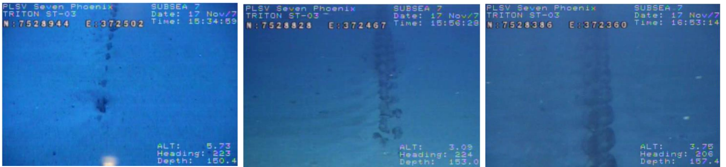
Figura 6.2.3-II: Fotos tiradas durante inspeção da linha de ancoragem #1, em 2017, mostrando (da esquerda para a direita): posição da âncora, amarra apoiada no leito marinho e região do TDP.
