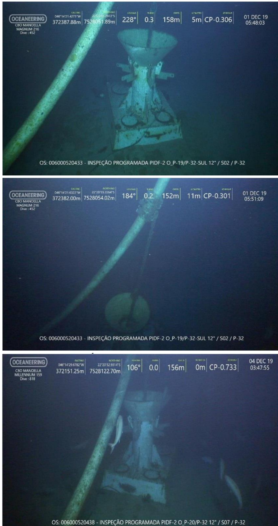
Figura 5.IX: Pesos mortos dos sistemas pliant wave dos risers dos Oleodutos P-19/P-32 Sul (fotos superior e intermediária) e P-20/P-32 (foto inferior). Fotos tiradas durante inspeções realizadas em 2019.
