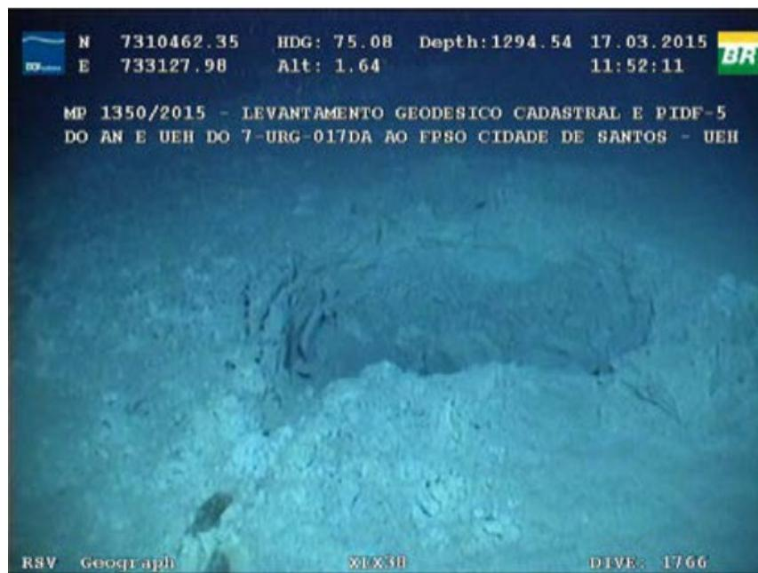
*Figura 3.3-I – Detalhe da cratera do torpedo de ancoragem do UEH do poço 7-URG-017DA.*
