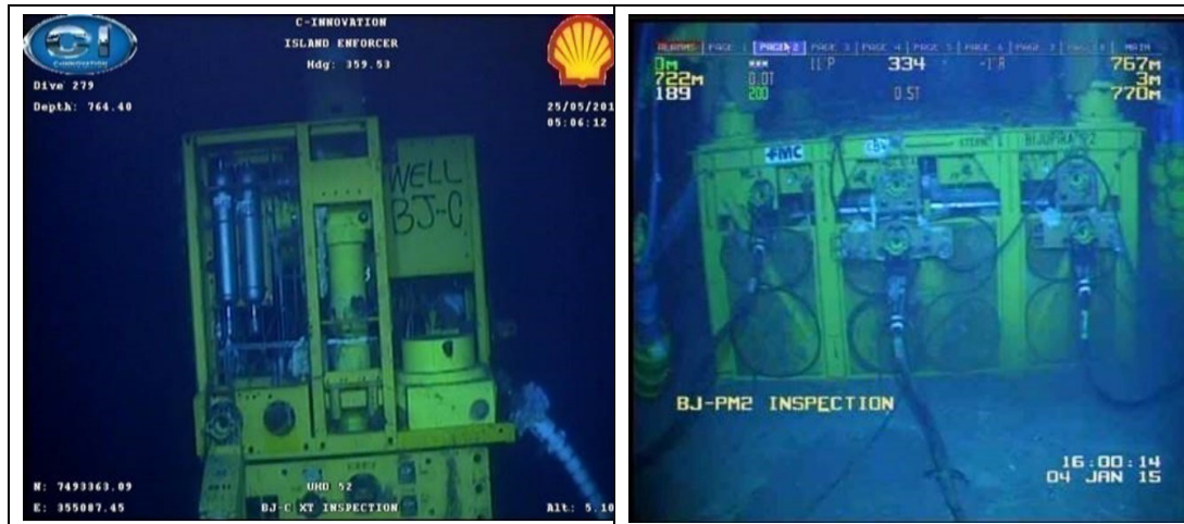
Figura 3.5.1.2 – Árvore de natal do poço BJ-C à esquerda e Manifold de produção de Bijupirá à direita
