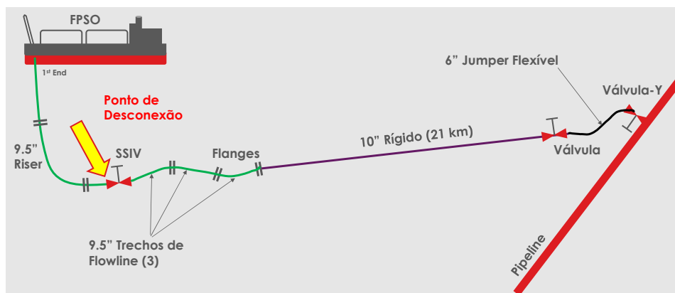
Figura 5.2.4.2 – Ponto de desconexão da linha de exportação de gás de BJSa
