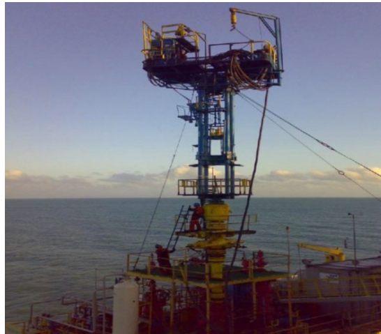
Figura 11: Exemplo de Sonda de Produção Hidráulica (SPH).
