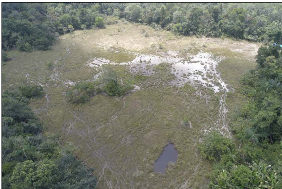
Figura 43: Processos erosivos em sulcos e um pequeno acúmulo de água próximo à borda da localização do poço 1-SOJ-1-AM.
