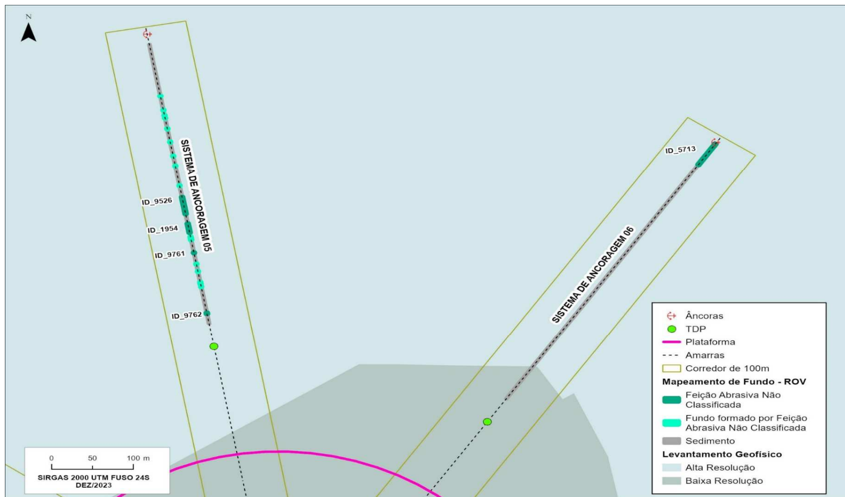
Figura 5: Detalhe das amarras #5 e #6 mostrando os tipos de fundo caracterizados através de inspeção com ROV.
