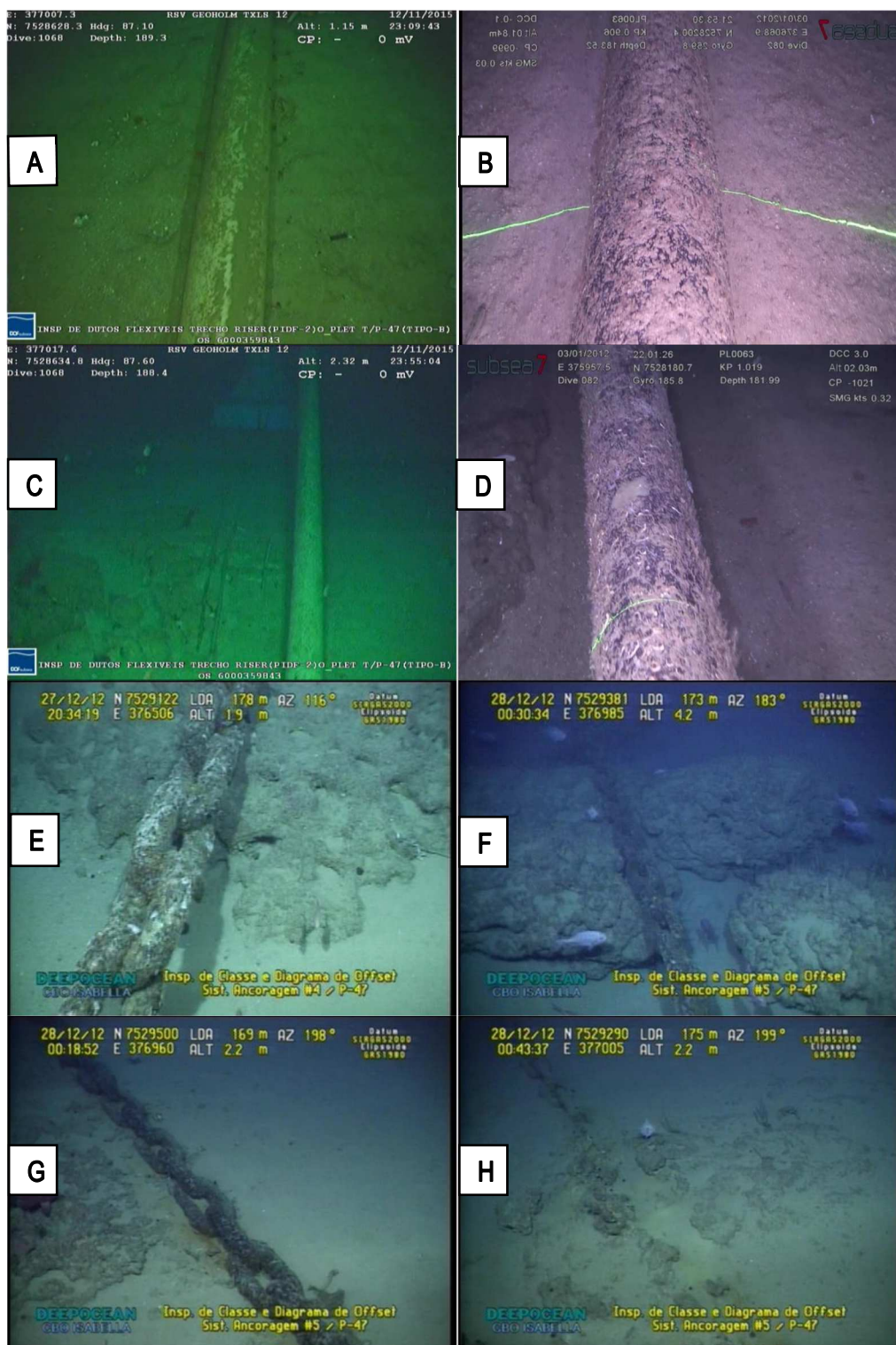
Figura 8 – Exemplos de tipos de fundo identificados sob os oleodutos: (A-B) Sedimento; (C-D) Feições abrasivas não classificadas; e sobre as amarras do sistema de ancoragem: (E-F) Feições abrasivas não classificadas; (G-H) Fundos formados por feições abrasivas não classificadas.
