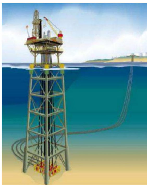
FIGURA 6: PLATAFORMA TIPO JAQUETA OKUME DA MODEC, OPERANDO NA COSTA DA GUINÉ, ÁFRICA.
