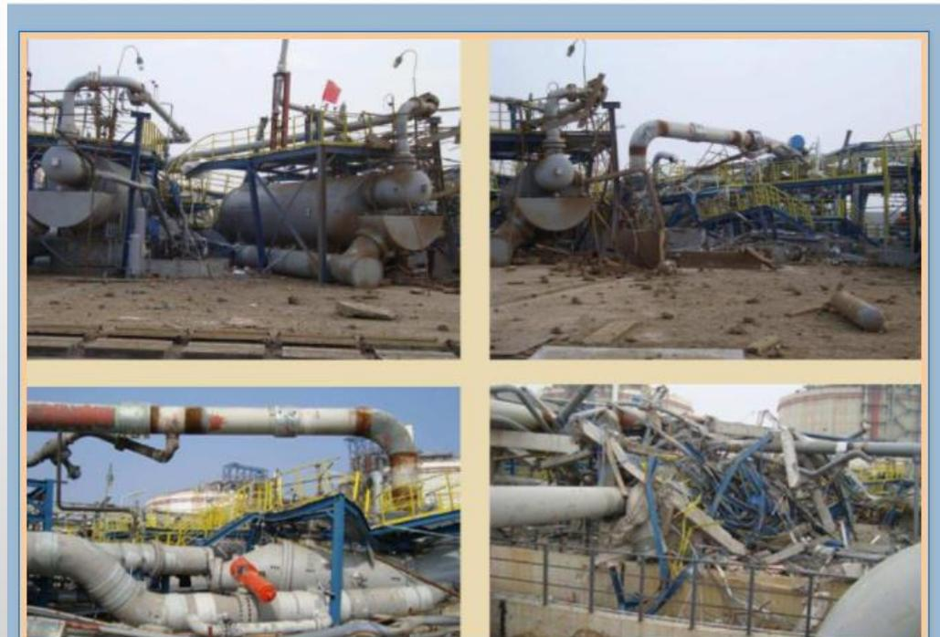
Entorno da explosão completamente destruído pelo deslocamento de ar e pelos estilhaços da tubulação.
