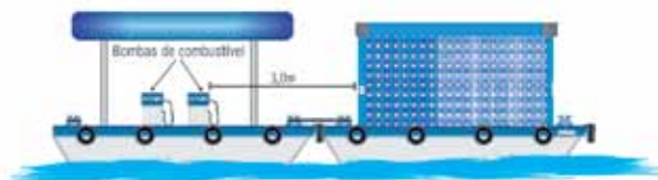
Balsa de armazenamento de GLP Classe III ou superior: para o armazenamento de GLP neste exemplo, anexa a um pontão.
