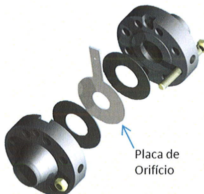
Figura 4.1 – Placa de Orifício entre Flanges
