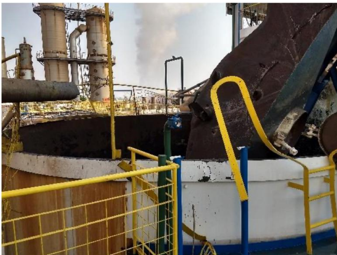
Figura 12 – Teto rompido da dorna volante 1 (fonte: Registro fotográfico da empresa)
