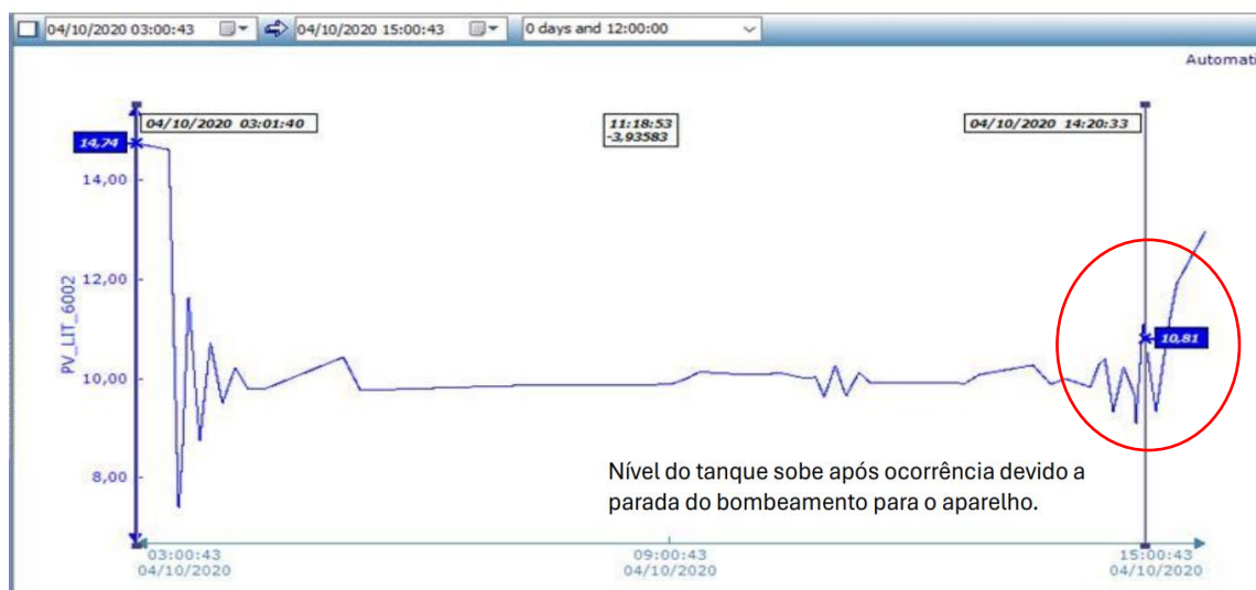
Figura 14 – Monitoramento de nível da Dorna Volante 1 - 12 horas antes do acidente
