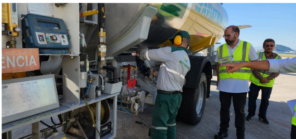
Foto VI.2 – Realização da amostragem do JET A pelo operador do CTA durante o abastecimento da aeronave no Aeroporto Santos Dumont/RJ.
