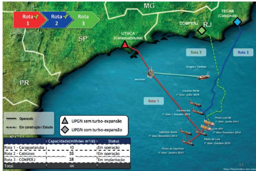
Figura 6 – Rotas de escoamento do gás natural oriundo dos reservatórios da bacia de Santos
