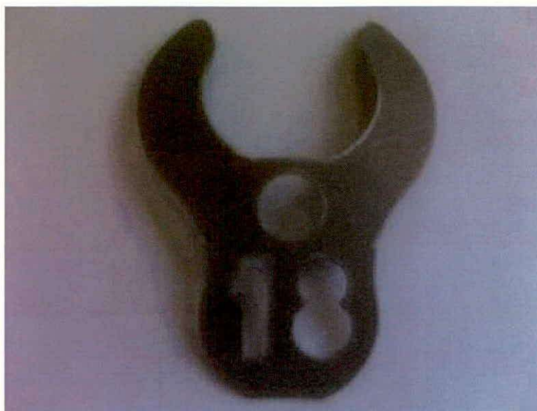
FIGURA 10 – PLAQUETA DE IDENTIFICAÇÃO COM O ANO DA PRÓXIMA REQUALIFICAÇÃO VAZADA
