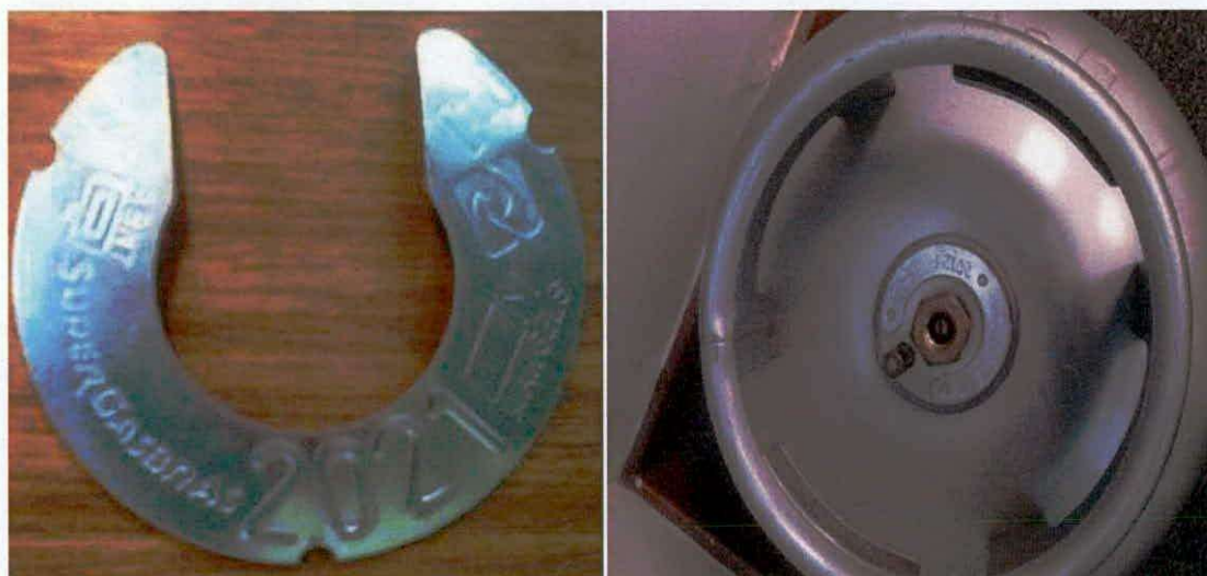
FIGURA 9 – PLAQUETAS DE IDENTIFICAÇÃO COM O ANO DA PRÓXIMA REQUALIFICAÇÃO EM ALTO RELEVO
