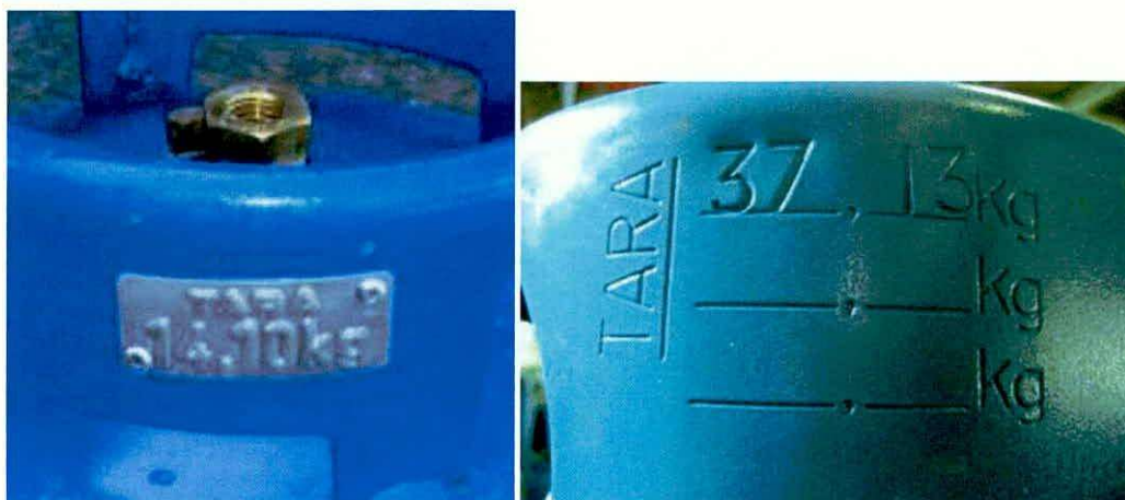
FIGURA 5 – TARAS COM A IDENTIFICAÇÃO DO PESO DO RECIPIENTE VAZIO
