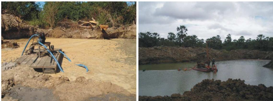
Figura 3.12 – Extração de areia por dragagem em duas áreas localizadas na planície de inundação do rio Pacoti, município de Aquiraz.
