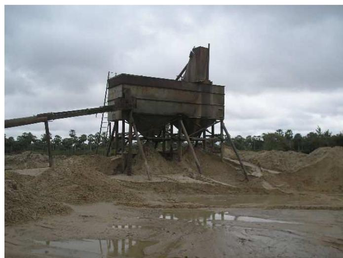
Figura 3.24 – Silo desaguador utilizado em área de extração de areia grossa na planície de inundação do rio Pacoti, município de Aquiraz.
