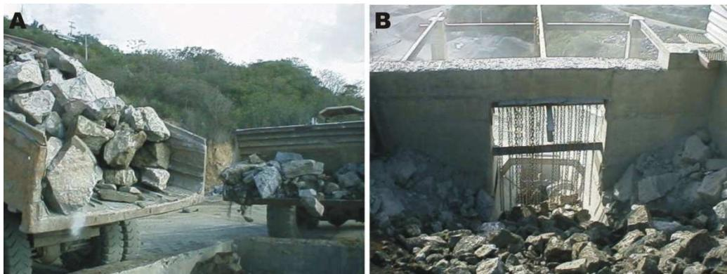
Figura 2.32 – Caminhão descarregando material na caixa de alimentação do britador primário (A) e alimentador vibratório(B). Município de Pacatuba.
