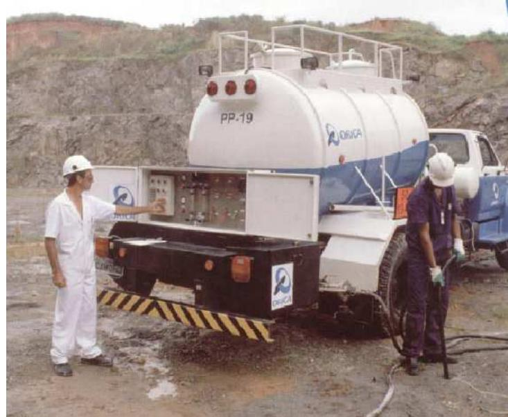
Figura 2.21 – Exemplo de carregamento dos furos através de bombeamento de emulsão tipo *powergel SE* (emulsão explosiva pura), realizado pela empresa Orica do Brasil S.A. Fonte: Quaglio, 2003.
