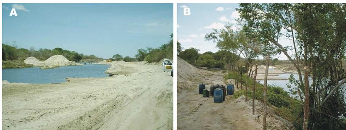
Figura 3.25 – Extração de areia grossa em leito ativo, observando-se alterações no canal fluvial e interferências na APP. A – área no município de Aracoiaba; B – área no município de Chorozinho.
