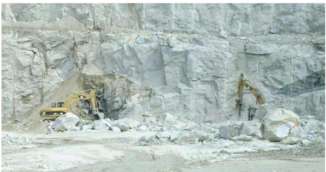
Figura 2.27 – Escavadeira e rompedor hidráulico em operação em pedreira do município de Itaitinga.
