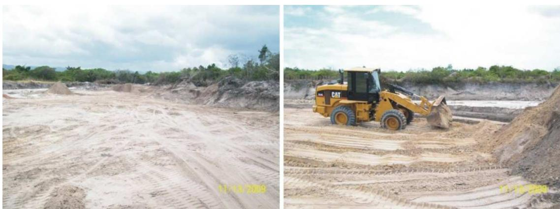
Figura 3.20 – Aspecto de áreas de extração de areia fina (vermelha) por desmonte mecânico no município de Caucaia.
