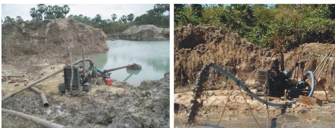
Figura 3.13 – Extração de areia por dragagem, com as bombas montadas na margem das cavas, em duas áreas localizadas na planície de inundação do rio Pacoti, município de Aquiraz.
