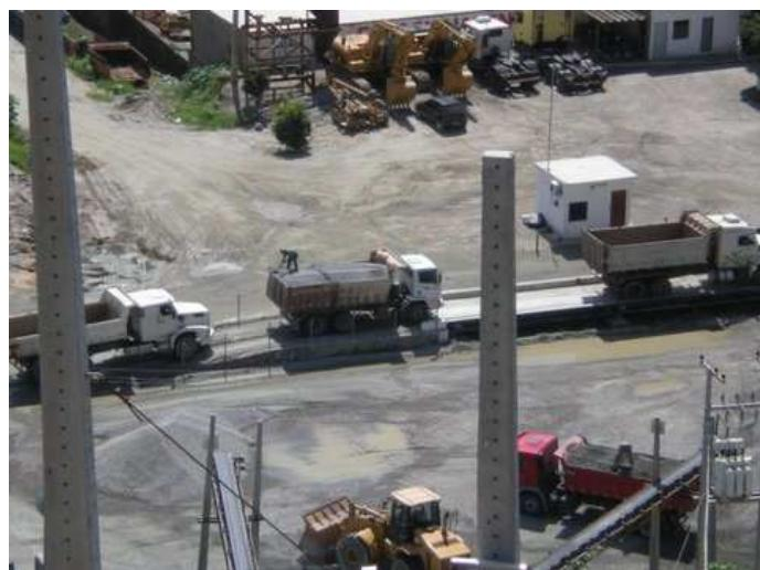
Figura 2.38 – Balança utilizada no embarque para pesagem da produção de brita comercializada em pedreira do município de Caucaia.
