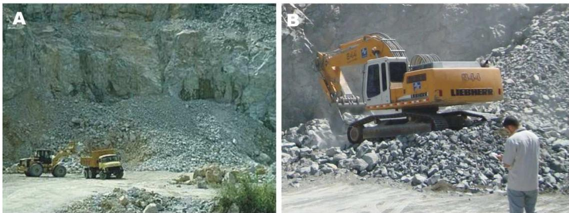
Figura 2.26 – Pá carregadeira e retroescavadeira utilizadas no carregamento dos caminhões para transporte da rocha para o britador primário em pedreiras localizadas nos municípios de Itaitinga (A) e Eusébio (B).
