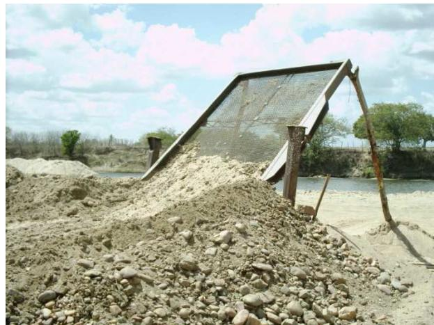
Figura 3.23 – Peneira estática usada para beneficiamento de areia grossa extraída no leito do rio Choró. Município de Barreira.
