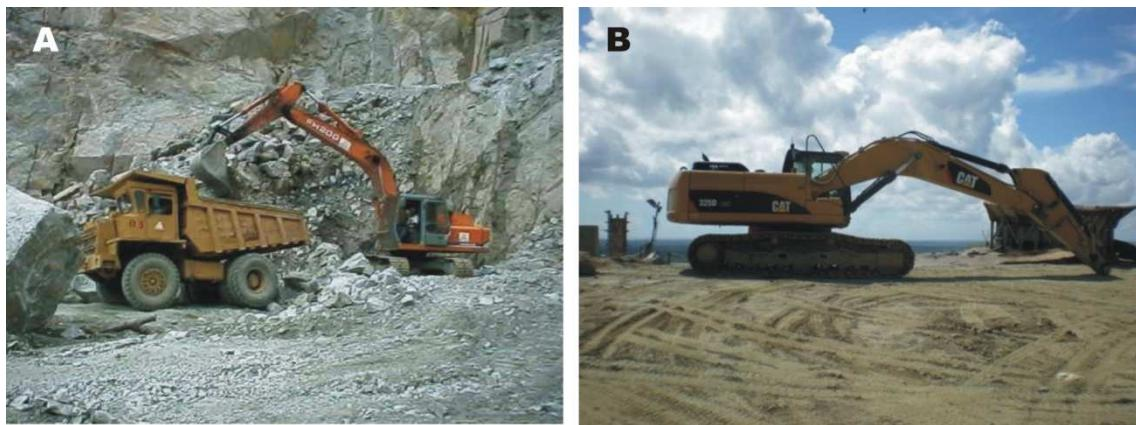
Foto 2.25 – Retroescavadeiras utilizados no carregamento dos caminhões para transporte da rocha para o britador primário em pedreiras localizadas nos municípios de Pacatuba (A) e Caucaia (B).
