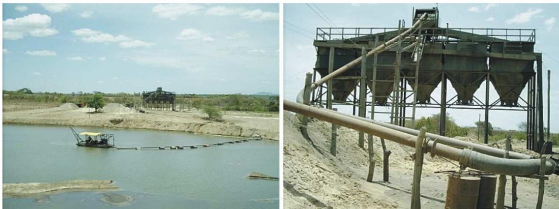
Figura 3.24 – Aspecto geral da dragagem, do beneficiamento e detalhe do silo desaguador utilizado em área de extração de areia grossa no rio Choró, município de Chorozinho.
