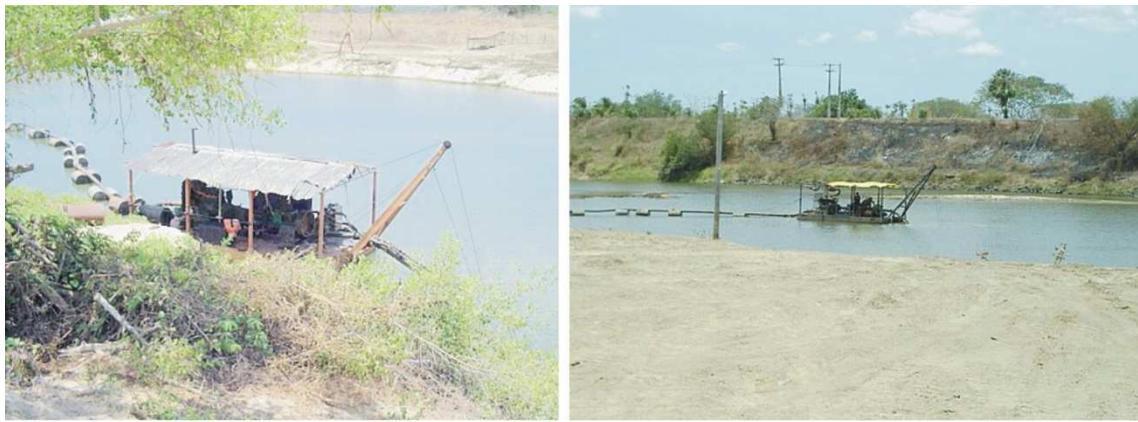
Figura 3.11 – Extração de areia por dragagem no leito do rio Choró, em duas áreas localizadas no município de Chorozinho.
