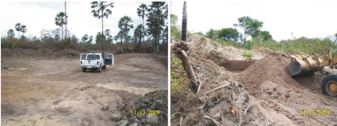
Figura 3.22 – Aspecto de áreas de extração de areia fina (arisco) por desmonte mecânico no município de Caucaia.
