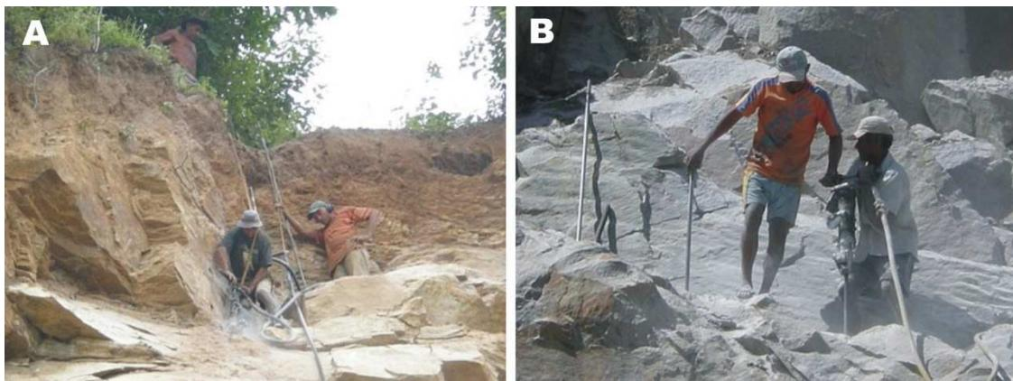
Figura 2.20 - Perfuração realizada com marteletes manuais acionados por compressores móveis a diesel, em que não são utilizados os equipamentos de segurança obrigatórios. A – Pedreira localizada no município de Caucaia; B – Pedreira localizada no município de Itaitinga.
