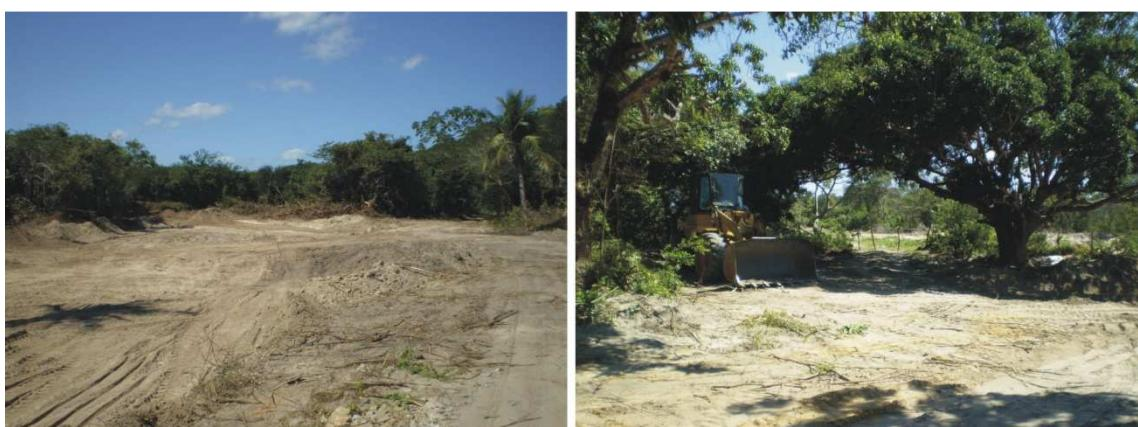
Figura 3.21 – Aspecto de áreas de extração de areia fina (arisco) por desmonte mecânico no município de Caucaia.
