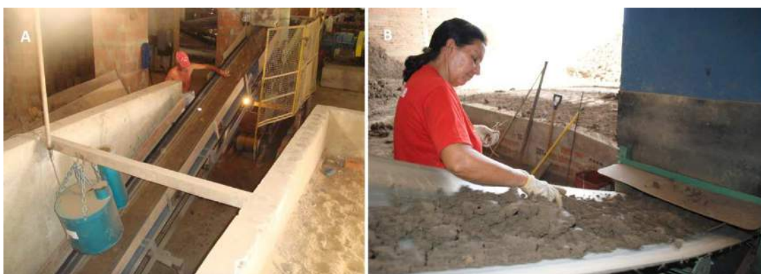
Figura 7.15 – Esteira com imãs e catação manual (A); detalhe da catação manual (B), municípios de Jaguaruana e Russas.
