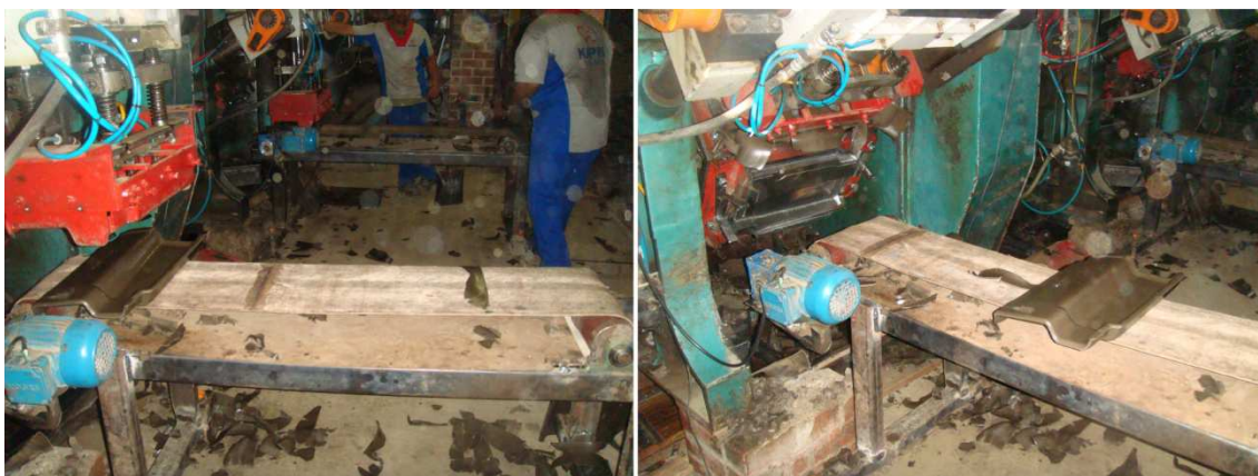
Figura 7.24 – Aspecto da saída da prensa, concluindo o processo de conformação da telha prensada. Município de Russas.
