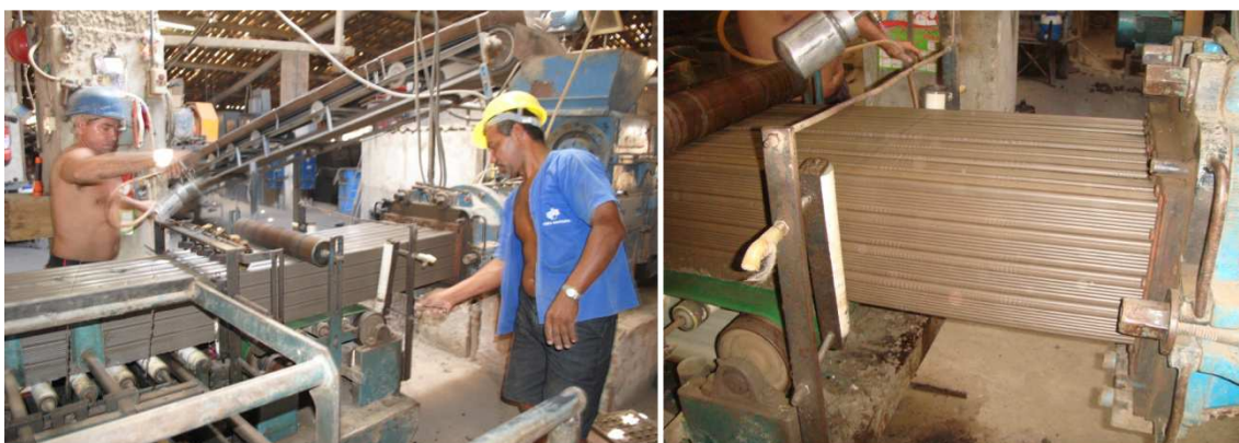
Figura 7.18 – Extrusora ou maromba em operação para fabricação de tijolo furado. Município de Jaguaruana.
