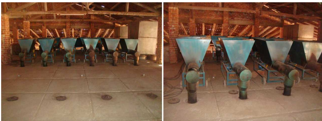
Figura 7.33 – Vista da parte superior de forno contínuo e detalhe da alimentação mecanizada de combustível. Município de Russas.
