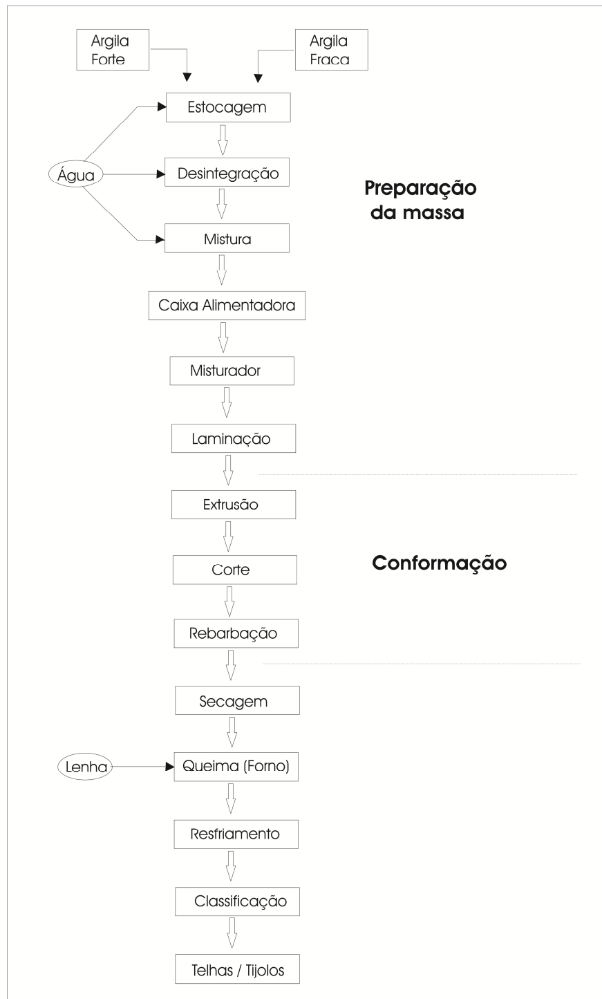
Figura 7.9 – Fluxograma do processo produtivo da indústria cerâmica do Baixo Jaguaribe para fabricação de telha extrusada e tijolo furado (modificado de Paula Pessoa, 2004).
