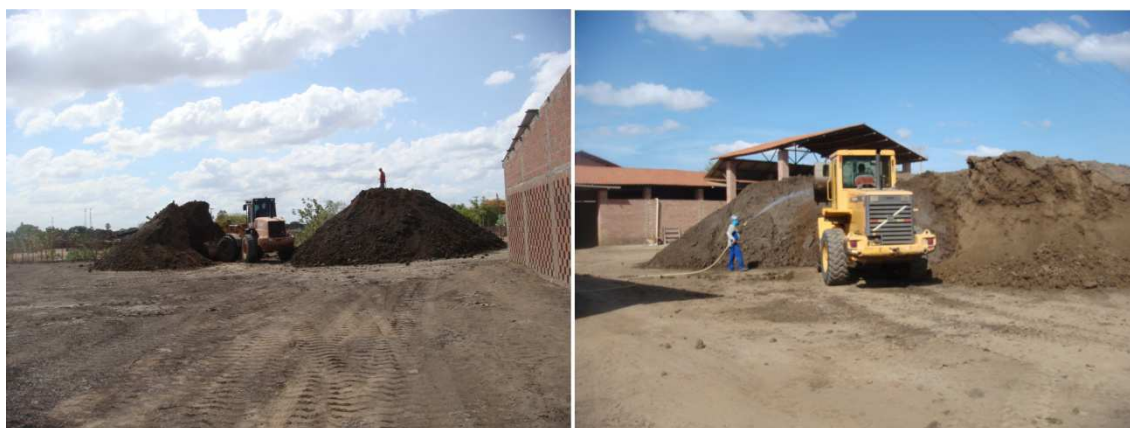
Figura 7.11 – Mistura e pré-umidificação na preparação da massa em cerâmicas do município de Russas.
