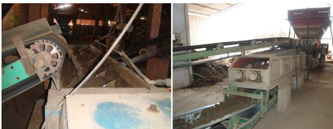
Figura 7.13 – Exemplos de misturadores utilizados na indústria cerâmica do município de Russas, em que pode ser observada a esteira de retorno para o reaproveitamento de peças defeituosas e retalhos do corte.
