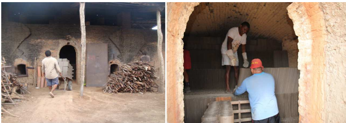
Figura 7.28 – Entrada e interior do forno tipo abóbada. Distrito de Flores, Russas.
