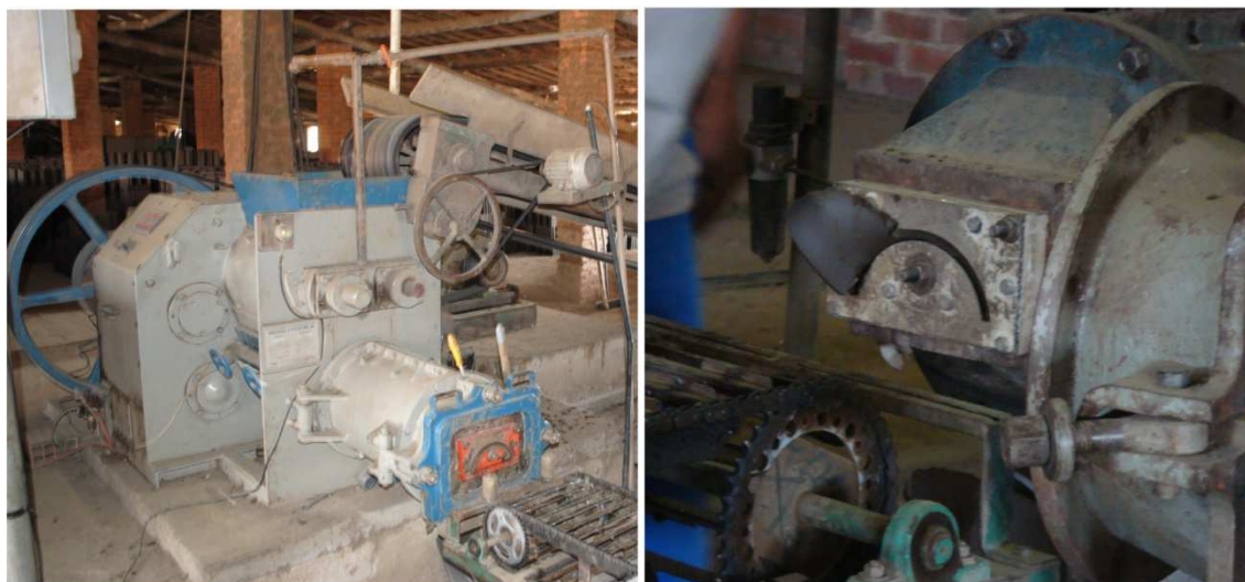
Figura 7.16 – Vista geral da extrusora e detalhe da boquilha com o perfil para conformação da telha colonial extrusada. Município de Russas.
