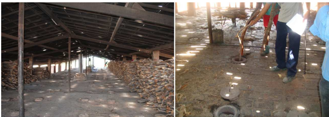
Figura 7.32 – Vista da parte superior de forno contínuo e detalhe da alimentação manual de combustível. Município de Jaguaruana.
