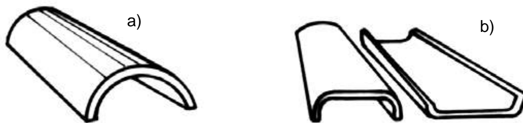
Figura 5.4 - Telha cerâmica tipo paulista (a), plana de sobreposição (b). Adaptado de Araújo et al , 2000.
