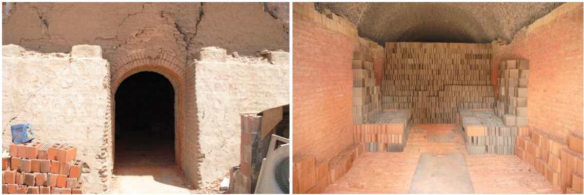
Figura 7.29 – Entrada e interior do forno tipo paulista com dezesseis bocas de alimentação ou fornalhas de queima. Município de Jaguaruana.
