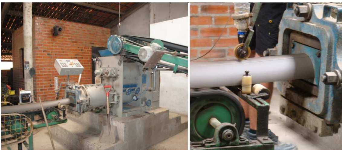
Figura 7.17 – Extrusora ou maromba em operação para fabricação de telha colonial extrusada. Município de Russas.
