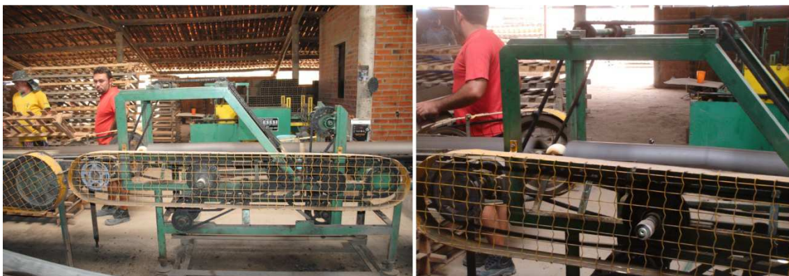
Figura 7.19 – Máquina de corte em operação para fabricação de telha colonial extrusada. Município de Russas.
