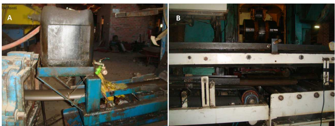
Figura 7.23 – Processo de fabricação da telha prensada: (A) saída da extrusora ou maromba; (B) máquina de corte. Município de Russas.
