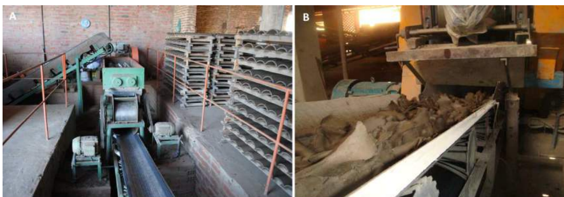
Figura 7.14 – Laminadores utilizados na indústria cerâmica do Baixo Jaguaribe. (A) Conjunto misturador-laminador, município de Russas; (B) material cerâmico após a laminação, município de Jaguaruana.
