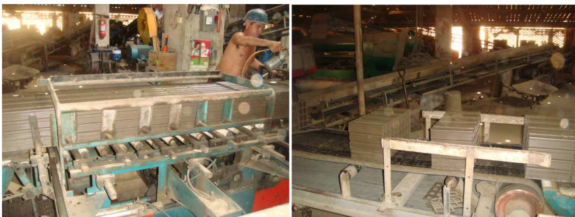
Figura 7.20 – Máquina de corte em operação para fabricação de tijolo furado. Município de Jaguaruana.
