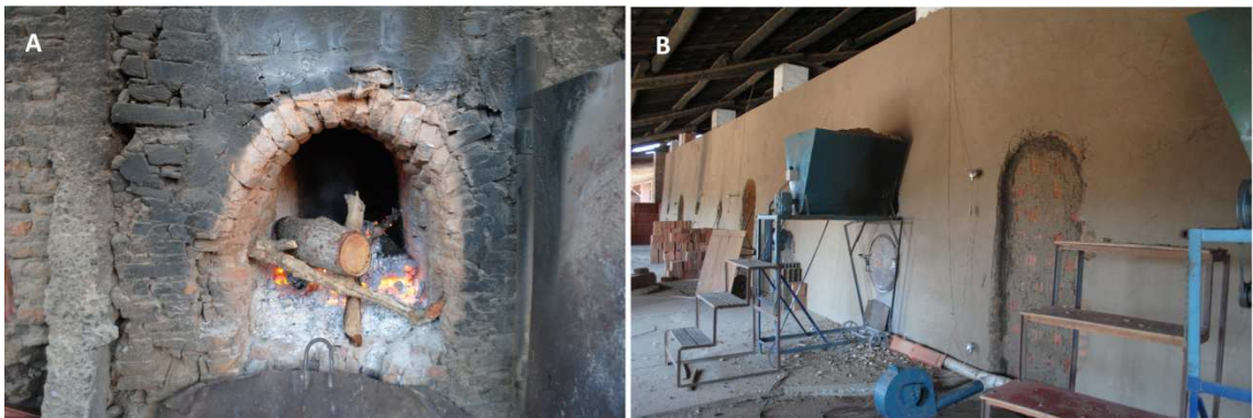
Figura 7.30 – Bocas de alimentação ou fornalhas de queima em fornos intermitentes. (A) forno abóbada com alimentação manual de lenha; (B) forno quadrado com alimentação mecanizada de lenha triturada e aditivos, em que o fogueiro apenas enche a caixa, sendo a quantidade de combustível e o tempo de alimentação automatizados. Município de Russas.
