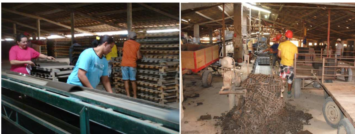
Figura 7.21 – Peças úmidas retiradas da esteira manualmente para seguirem para secagem. Observar as rebarbas do corte, que retornam ao misturador para reaproveitamento. Município de Russas e Jaguaruana.
