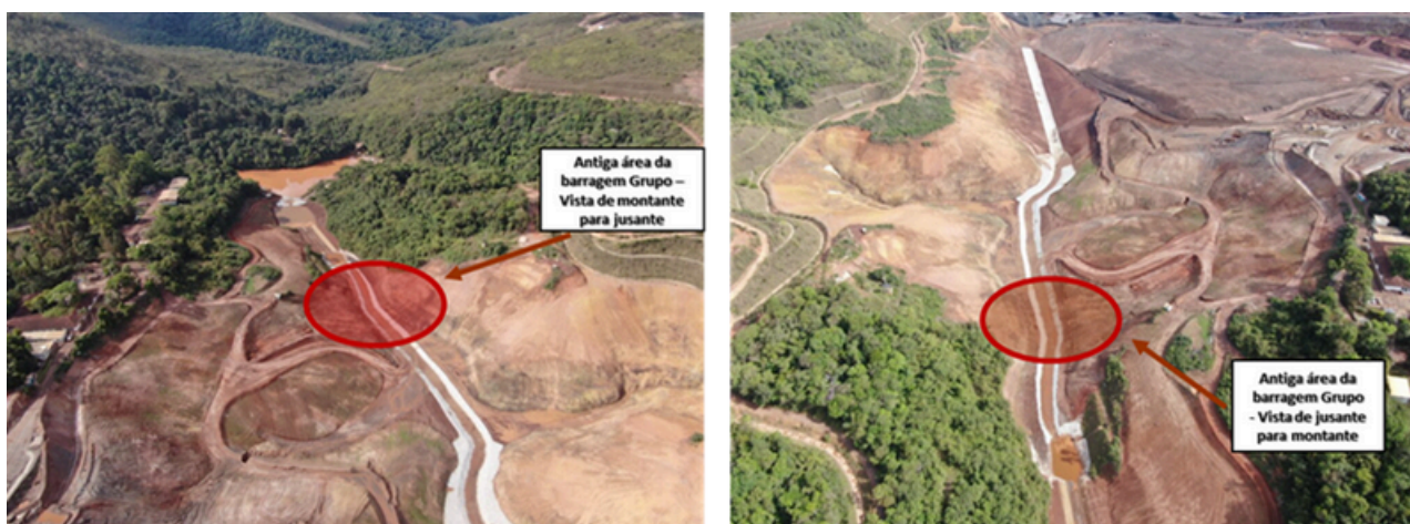
Condição final da região da antiga Barragem Grupo, ao término das obras de remoção do barramento. Fonte: ANM, 2025.
