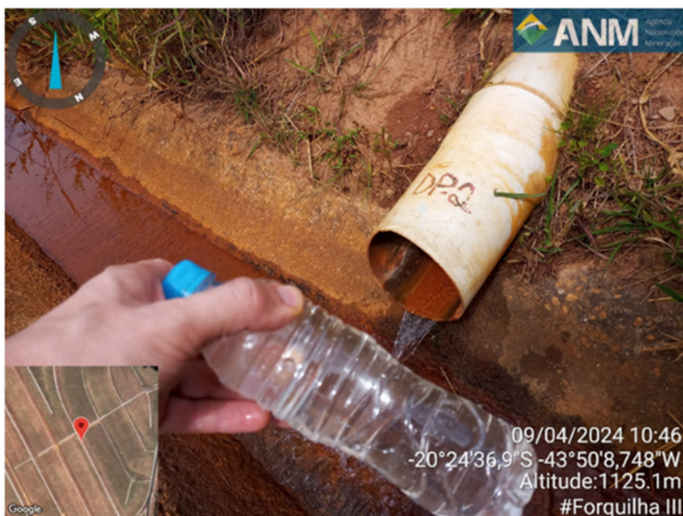
Amostra de água coletada diretamente no dreno DP-2, indicando visualmente baixo índice de turbidez no momento da vistoria
