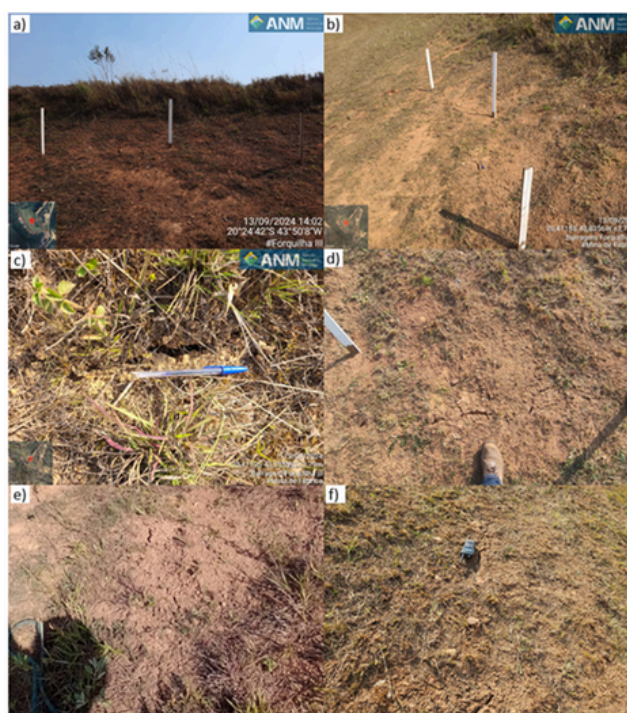
Registro das trincas: a), b), c) e d) trincas preliminares identificadas pela VALE S.A.; e) e f) trincas identificadas em campo pela ANM
