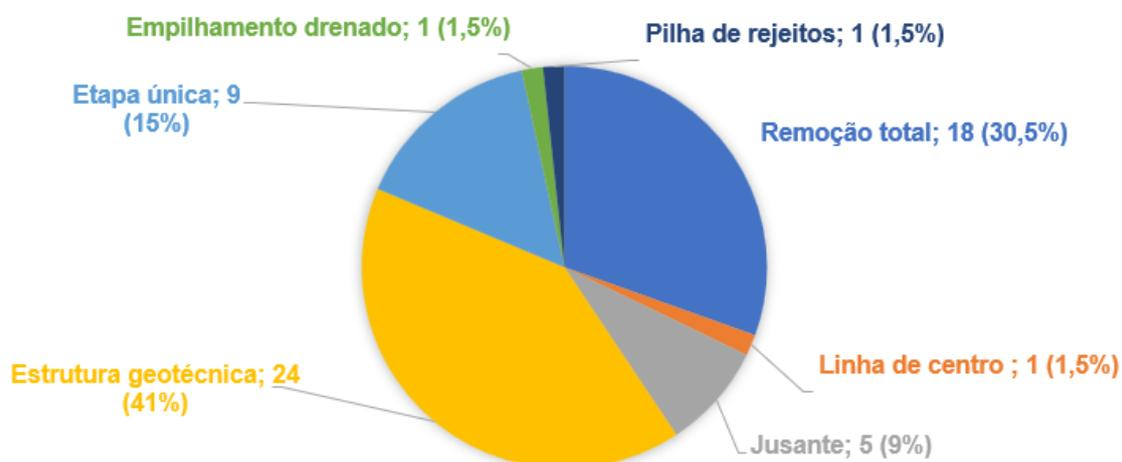
Figura 06 – Distribuição da nova configuração geométrica das barragens a montante durante seu processo de descaracterização.
