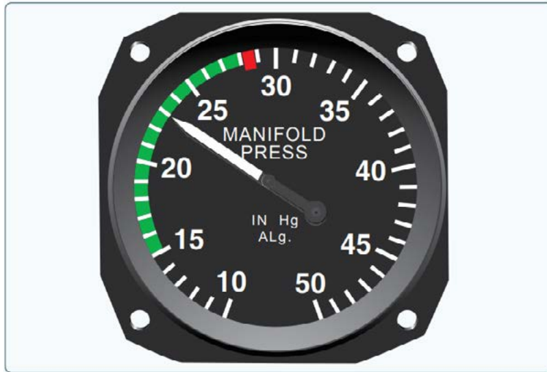
Figura 9. A potência de saída do motor é indicada no manômetro de pressão do coletor.
