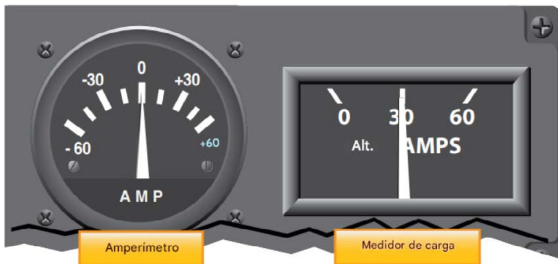
Figura 35. Amperímetro e medidor de carga (loadmeter).
