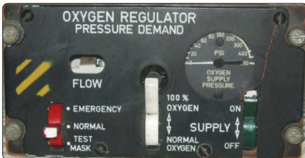
Figura 43. Regulador do sistema de oxigênio.
