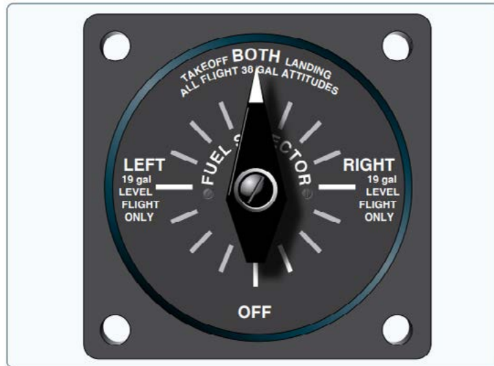
Figura 31. Válvula seletora de combustível.
