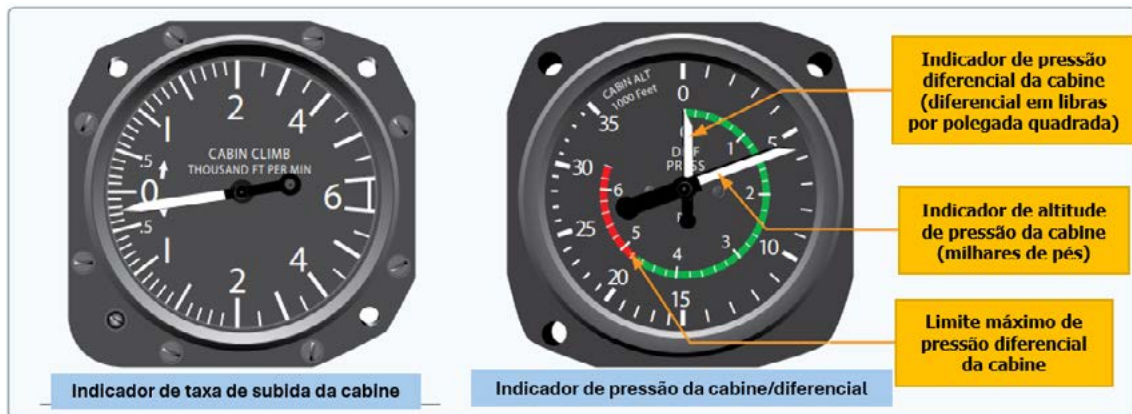
Figura 42. Instrumentos de pressurização da cabine.
