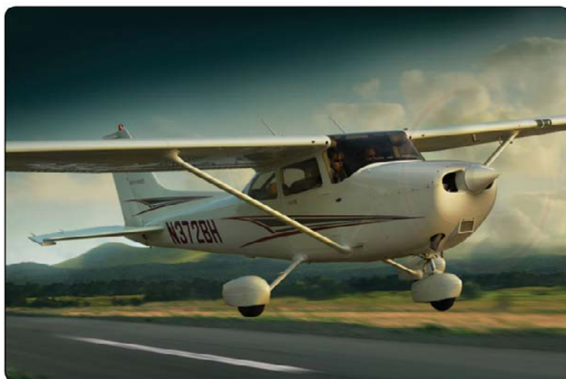
Figura 37. O trem de pouso apoia o avião durante a corrida de decolagem, pouso, taxiamento e quando estacionado.
