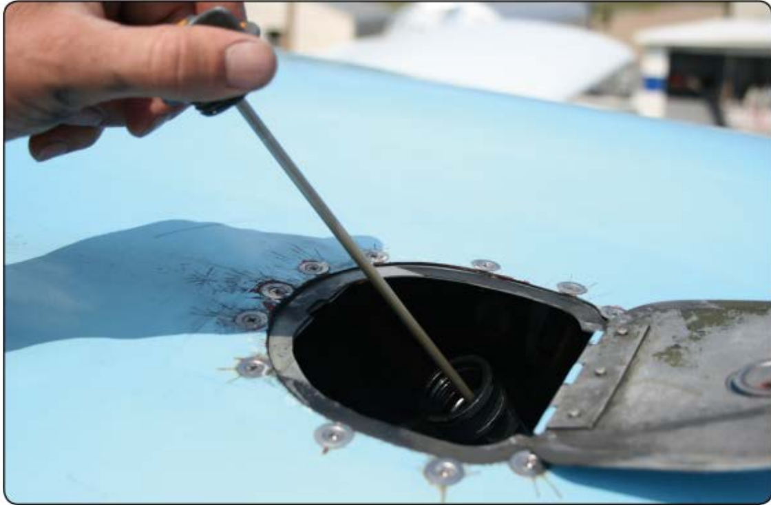
Figura 18. Sempre verifique o nível de óleo do motor durante a inspeção pré-voo.
