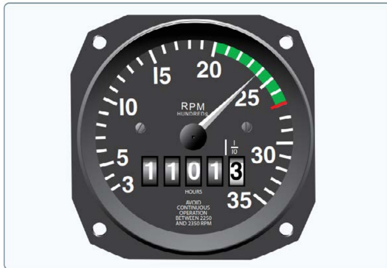
Figura 8. A rotação do motor é indicada no tacômetro.
