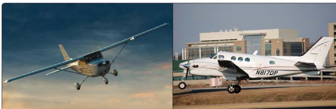
Figura 39. Aviões com trem de pouso fixo (esquerda) e retrátil (direita).
