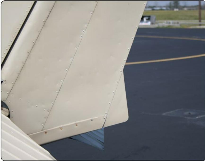
Figura 22. Um compensador ajustável no solo é usado no leme de muitos aviões pequenos para corrigir uma tendência de voar com a fuselagem ligeiramente desalinhada com o vento relativo.
