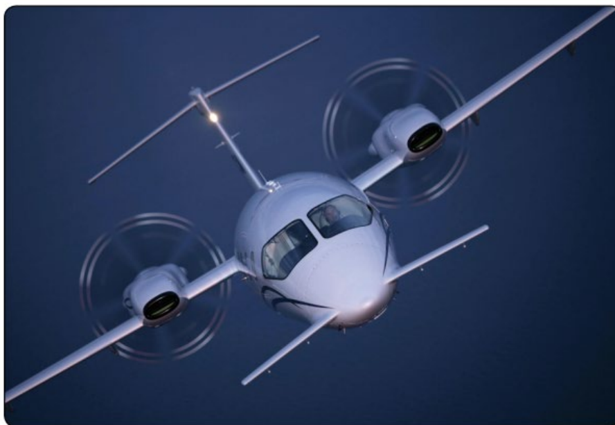
Figura 14. O Piaggio P180 inclui um design de canard de geometria variável que proporciona estabilidade longitudinal em torno do eixo lateral.
