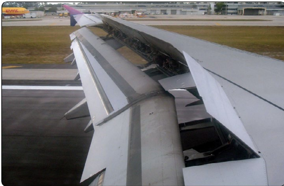
Figura 19. Os spoilers reduzem a sustentação e aumentam o arrasto durante a descida e o pouso.
