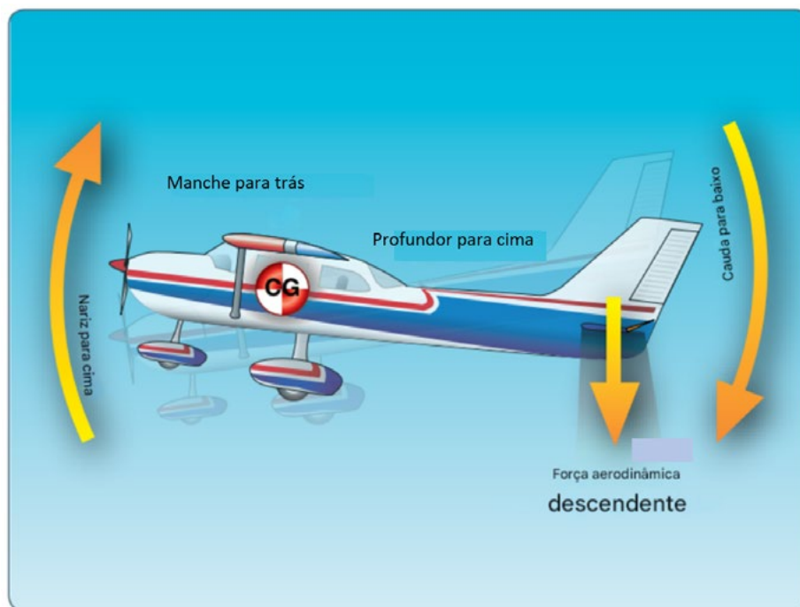
Figura 10. O profundor é o controle primário para alterar a atitude de arfagem de uma aeronave.
