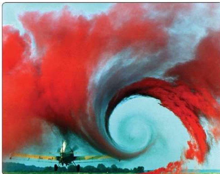
Figura 9. Vórtice da ponta da asa de um pulverizador agrícola.
