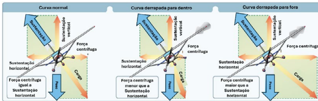
Figure 35. Curvas normais, deslizadas e derrapadas em altitude constante.
