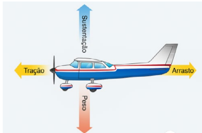
Figura 1. Relação de forças que atuam em uma aeronave.
