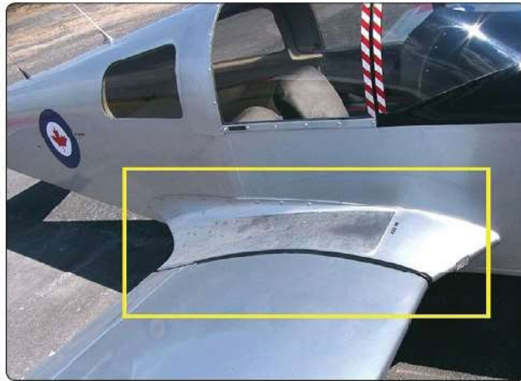
Figura 8. A raiz da asa pode causar arrasto de interferência.
