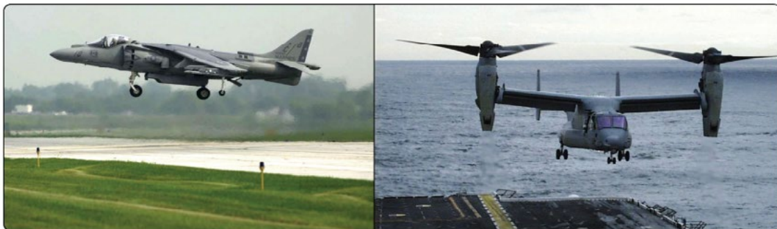
Figura 4. Algumas aeronaves têm a capacidade de mudar a direção do empuxo.
