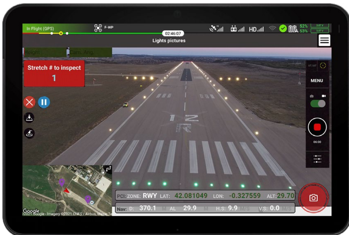
Figura 120. Utilização de software e IA para avaliação das luzes de balizamento. Fonte: ITE/Canard.
