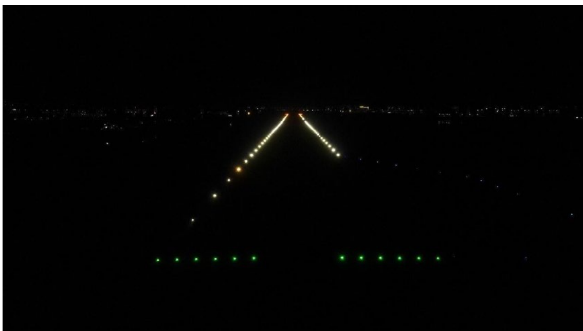
Figura 89. Teste de balizamento da THR 29 do Porto Alegre Airport (SBPA) – Brilho 5.
