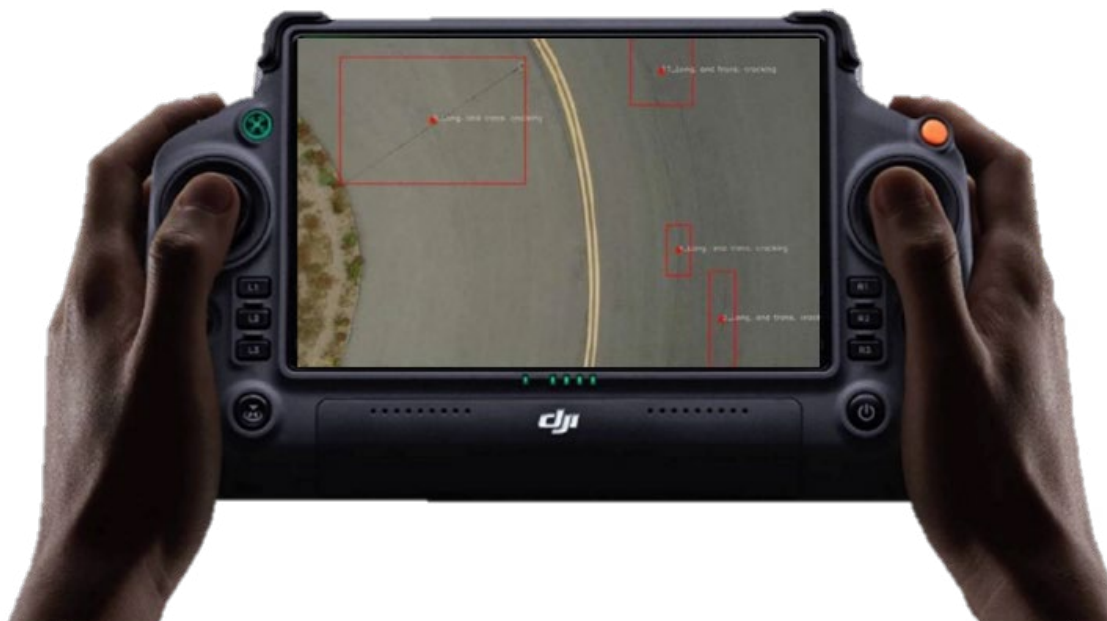
Figura 121. Utilização de software e IA para avaliação do PCI. Fonte: ITE/Canard.
