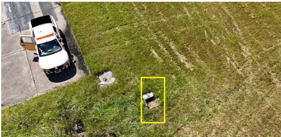
Figura 55. Imagem captada pelo drone registrando que a caixa de passagem estava com a tampa aberta - Zurich Airport Brasil (SBFL).
