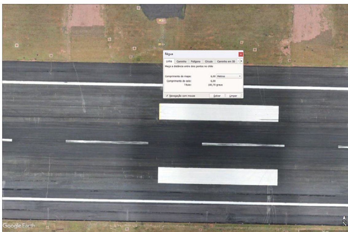
Figura 82. Medição da sinalização do ponto de visada da pista de pousos e decolagens de um ortomosaico do Porto Alegre Airport (SBPA) através do software Google Earth.
