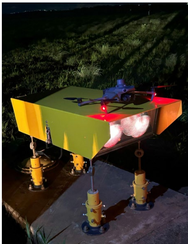
Figura 74. Etapa de coleta de coordenadas de cada caixa de PAPI para calibração no BH Airport (SBCF).
