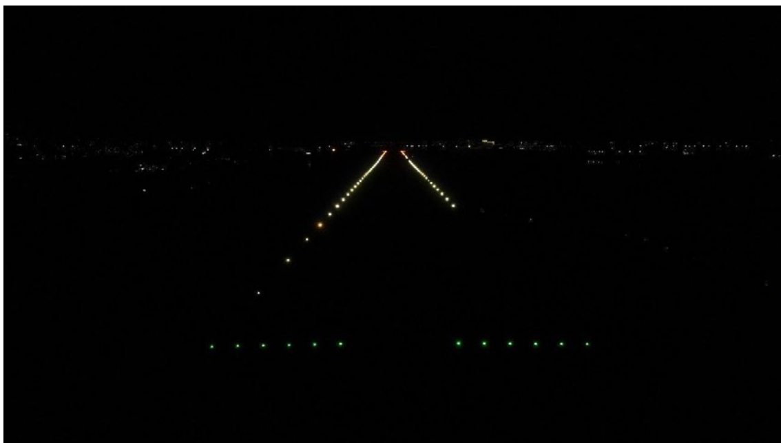
Figura 88. Teste de balizamento da THR 29 do Porto Alegre Airport (SBPA) – Brilho 4.
