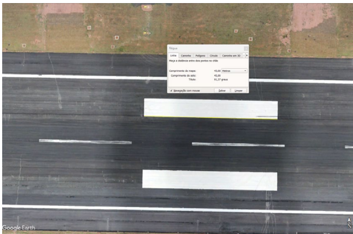
Figura 83. Medição da sinalização do ponto de visada da pista de pousos e decolagens de um ortomosaico do Porto Alegre Airport (SBPA) através do software Google Earth.
