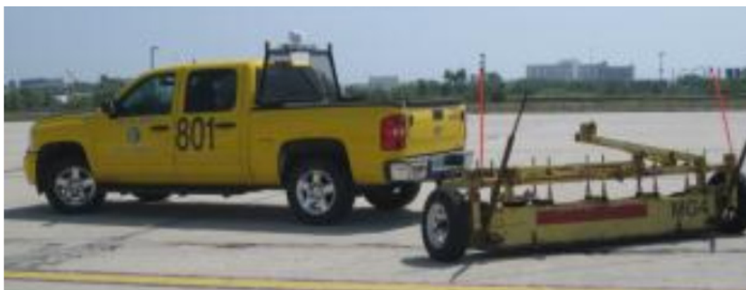
Figura 59: Barra magnética rebocadas pela pista. Aeroporto Internacional de Atlanta – O'Hare, 2012 (Edwin E. Herricks D. M., 2015).
