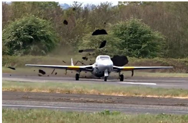
Figura 23: Pavimento deteriorado sendo lançado pela aeronave (Fonte: SWNS.com).
