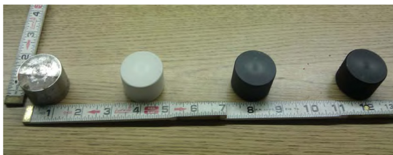
Figura 35: Alvos-padrão para avaliação da calibração FODetect System da Xsight (Edwin E. Herricks E. W., 2012a).
