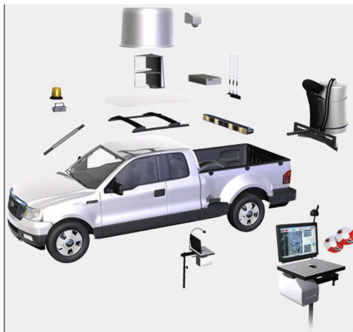
Figura 30: Radar instalado em um veículo de inspeção de pistas.
