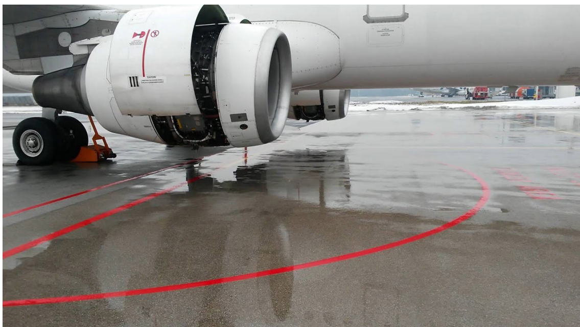
Figura 13: Alguns aeroportos pintam marcas de área de segurança de motores no chão. Se pintadas, podem considerar a área de segurança para potência de motor acima de "idle" (sem empuxo), além de considerar os diferentes motores e aeronaves que operam naquele pátio (Šušteršič, 2016).
