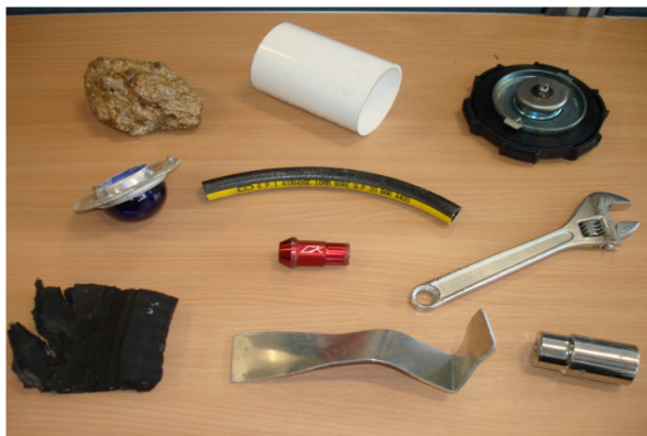
Figura 29: Objetos utilizados para aferir a precisão e eficácia de sistemas estacionários de detecção de FOD (FAA, 2009).
