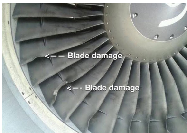
Figura 8: Danos severos às pás do motor de um avião a jato. Fonte: (Rigg, 2021) .
