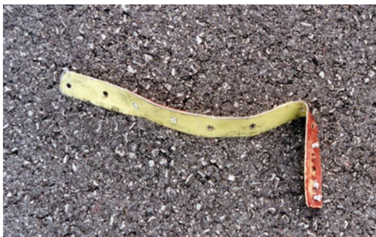
Figura 2: A faixa de metal com 43 cm que foi atingida pelo pneu do Concorde voo AF4590, fotografada na posição e no local onde foi encontrada na pista. Esta peça é conhecida como a " Concorde strip " (BEA, 2000).
