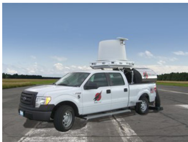
Figura 38: O Trex FOD Finder™ é construído com um design de radar patenteado que usa baixa potência de saída milimétrica (<0,05W) a frequência de 78-81 GHz e configuração de baixo perfil (1,5m x 1,5m x 1m <250 kg). ( FOD Finder , 2021). Fornece alta sensibilidade, baixo tempo de moradia, cobertura adequada e alta capacidade de resolução de localização. Ao contrário de um sistema eletro-óptico, o radar MMW funciona dia e noite e em todas as condições climáticas, incluindo neblina, chuva, neve e tempestades de areia e seu desempenho não é afetado pelo brilho do ar observado em altas temperaturas (Edwin E. Herricks P. L., 2012c).
