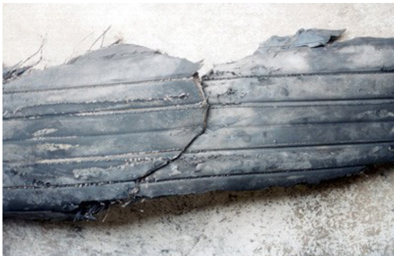
Figura 3: Parte de um dos pneus do Concorde voo AF4590, mostrando o corte provocado pela faixa metálica deixada na pista pelo Boeing DC-10 da Continental Airlines. A BEA concluiu que este pneu foi cortado e explodiu, lançando pedaços na parede inferior do reservatório de combustível número 5, que teve combustível vazado e depois incendiado (BEA, 2000).
