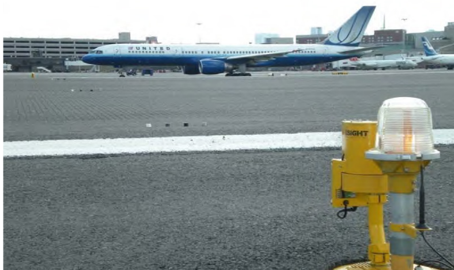
Figura 34: Teste de eficácia e precisão do FODetect Sensor da Xsight na pista do Aeroporto Internacional de Boston (BOS) (Edwin E. Herricks E. W., 2012a).
