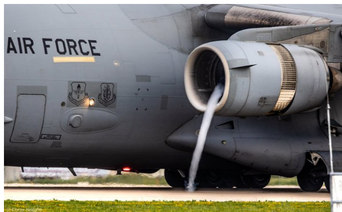
Figura 6: "Jetnado" - vórtice criado pelos motores do Boeing Globemaster C-17 da Força Aérea dos Estados Unidos devido à rápida queda de pressão na tomada de ar quando o piloto reverte os motores, com alta possibilidade de ingestão de FOD pelos motores a jato, com risco de danos severos (Knight, 2018). Alguns fabricantes de motores de aeronaves desenvolveram dissipadores de vórtices para diminuir o risco de ingestão de FOD (McCreary, 2011).
