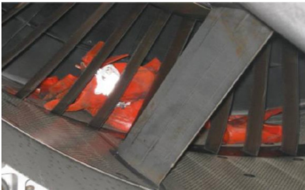
Figura 14: Ingestão de um cone por um motor de aeronave. Aeroporto Internacional de Belo Horizonte, 2021.
