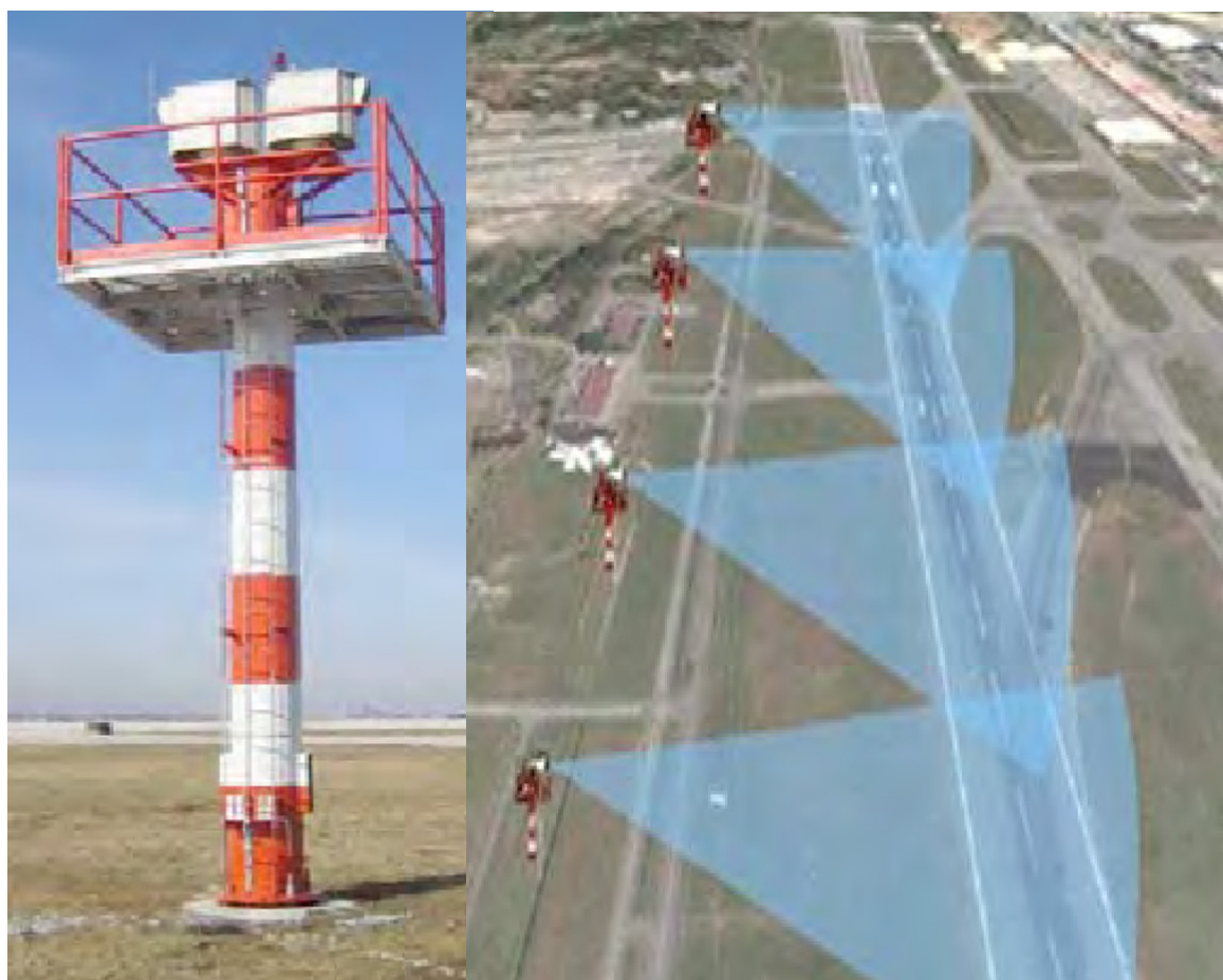
Figura 39: Equipamento fixo de detecção de FOD baseado em sistema eletro-óptico (Edwin E. Herricks P. L., 2012b)
