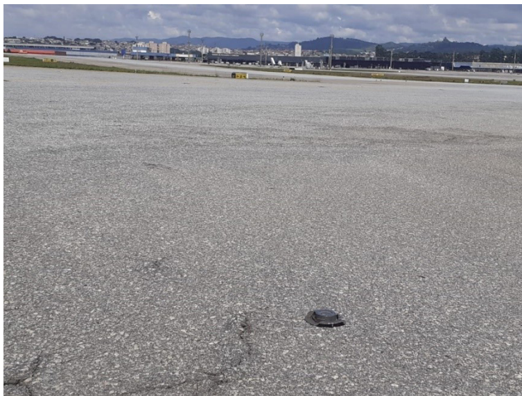
Figura 21: Tampa do tanque de combustível de aeronave deixada sobre táxi, Aeroporto Internacional de São Paulo-Guarulhos, 2022. Uma quantidade surpreendentemente alta de tampas de tanque de combustível de aeronaves tem sido encontrada como FOD em diversos aeroportos do mundo.
