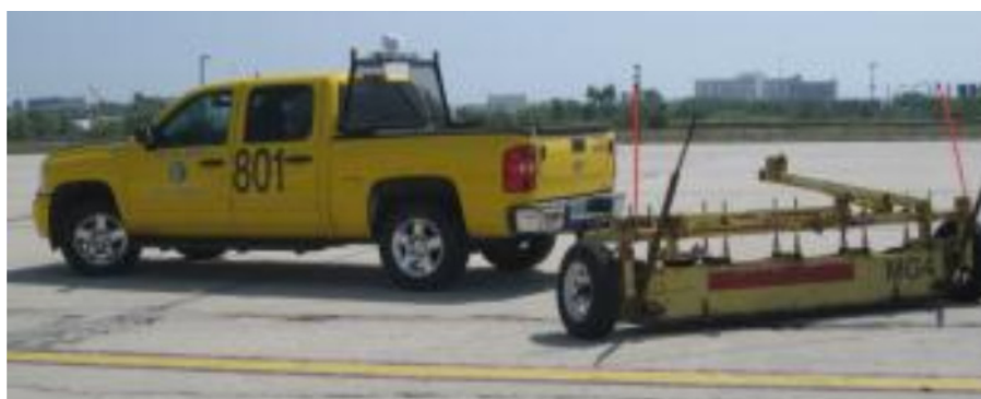
Figura 51: As barras magnéticas podem ter diversos modelos, e em geral são rebocadas por veículos (Edwin E. Herricks D. M., 2015).
