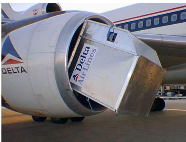
Figura 5: Equipamentos e materiais mal posicionados podem ser ingeridos por motores a jato, ou serem lançados a distância. Este Boeing 777-200 (9V-SRP), no aeroporto de Cingapura, em 19/12/2013, "ingeriu" um container de carga aérea mal posicionado e não amarrado no pátio. O motor teve que ser substituído (AAIB Singapore, 2015).
