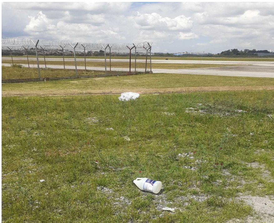
Figura 25: FOD em área não pavimentada adjacente à taxi no Aeroporto Internacional de São Paulo - Guarulhos, 2022. O FOD é movimentado pelo vento nas áreas do aeroporto, acumulando-se próximo às cercas.
