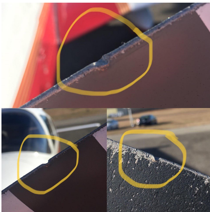
Figura 10: Detalhes dos "dentes" provocados por FOD nas pás das hélices de aviões. Algumas vezes ocorrem trincas e rupturas estruturais das pás das hélices (Reddit / Flying, 2021).
