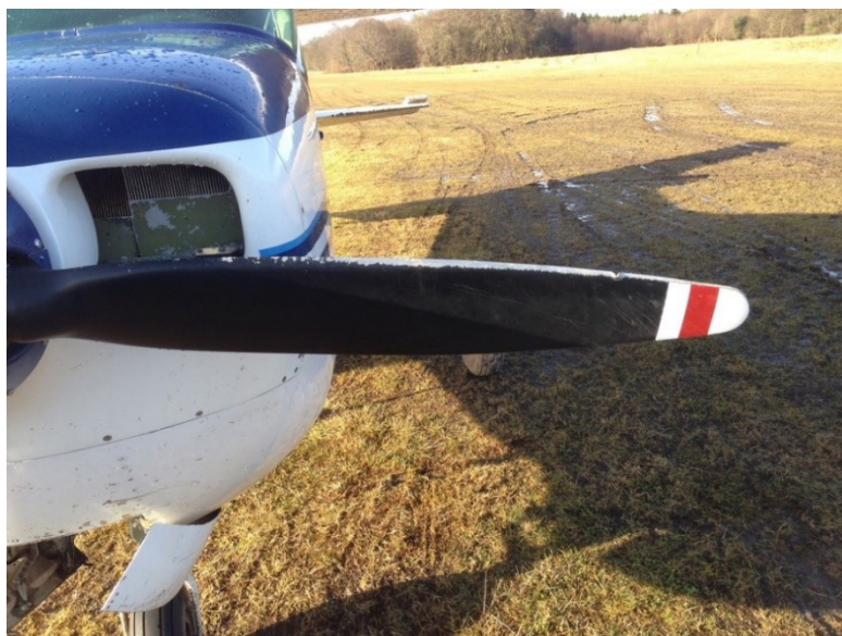
Figura 9: "Dente" na pá da hélice do avião (WilliamF, 2016).
