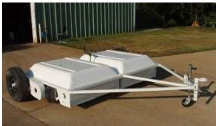
Figura 50: Barras magnéticas rebocadas por veículos podem ser utilizadas nas pistas e em outras áreas onde o FOD metálico e magnético oferece maior risco. Deve ser observado o acúmulo de material para que não caia depois de recolhido.
