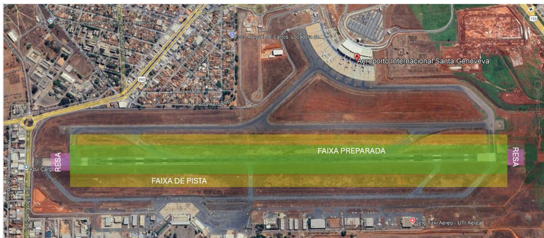
Figura 1 - Faixa de pista, faixa preparada e áreas de segurança (RESA).
