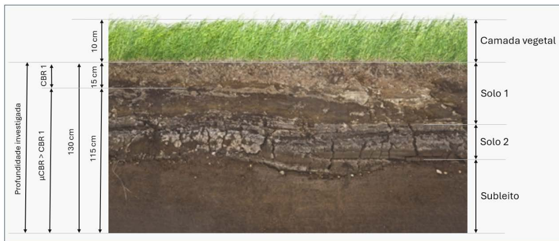
Figura 22 – Camadas investigadas e avaliação das resistências (CBR).
