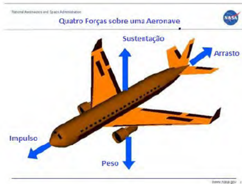
Figura 1: Esquema mostrando o balanço de forças que atuam sobre uma aeronave em voo. Fonte: NASA (2010).
