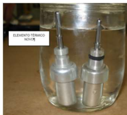
Figura 1 - Aquecedor de combustível e o elemento térmico com defeito (Pistão contraído)
