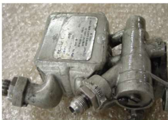
Figura 1 - Aquecedor de combustível e o elemento térmico com defeito (Pistão contraído)
