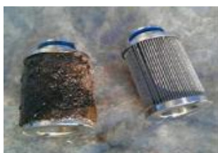
Filtro de Combustível contaminado
