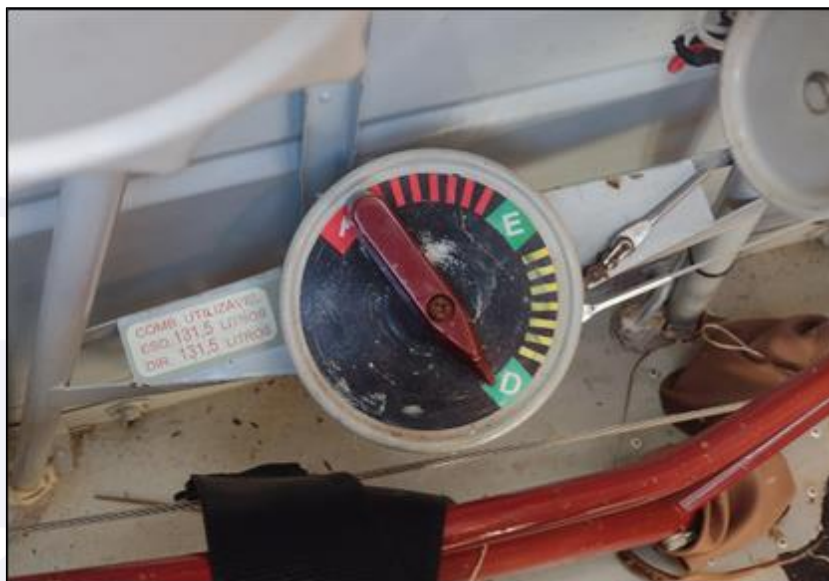
Figura 5 - Seletora do tanque de combustível na posição “D”, no sítio do acidente.
