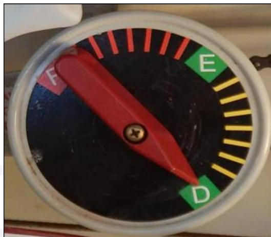
Figura 3 - Posições “D”, “E” e “F” da seletora de combustível do EMB-202A.
