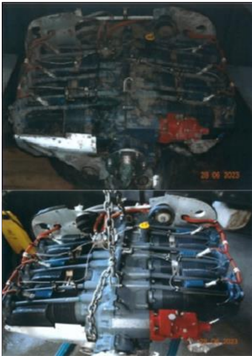
Figura 6 - Vista do motor SN L-33052-48E antes e depois da limpeza.
