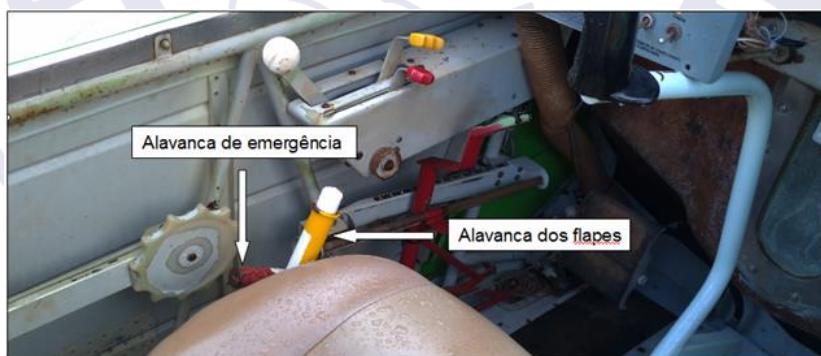
Figura 4 - Cabine de voo, com destaque para as alavancas de emergência e dos flapes.
